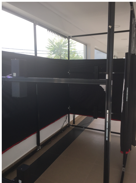
Figura 27. Espaço com luminosidade excessiva para a leitura dos sensores (do próprio autor, 2018).
