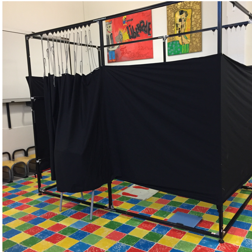
Figura 20. Cabine de digitalização do sistema KBI montada com a cortina preta (do próprio autor, 2018).
