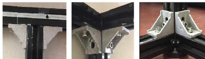
Figura 25. Braçadeiras de suporte das barras da cabine de digitalização do sistema KB (do próprio autor, 2018).
