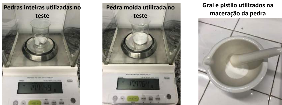
Figura 2. Pesagem de 17,7 g de dolomita inteira e moída para os testes em submersão de água pluvial.
