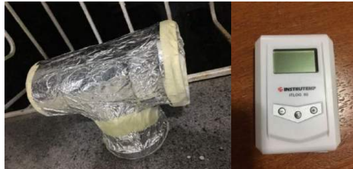
Figura 3. Abrigo de PVC e aparelho data-logger utilizados para as medições.
