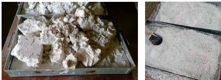
Figura 2. (a) Resíduo após secagem em estufa e (b) Resíduo destorroado.
