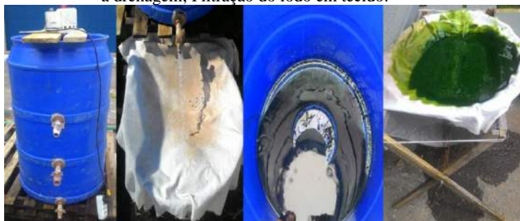
Figura 2. Processo de colheita do lodo algáceo com o uso de coagulantes
