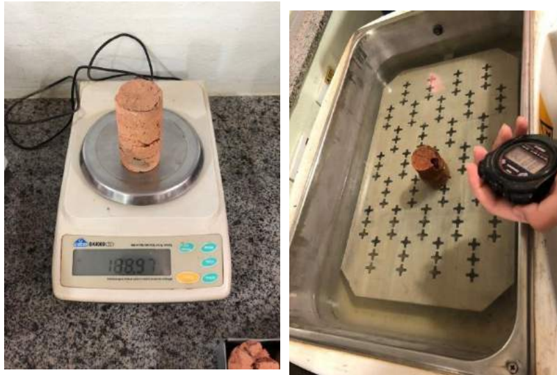
Figura 3. (a) Aferição da massa seca e (b) Ensaio índice de absorção.
