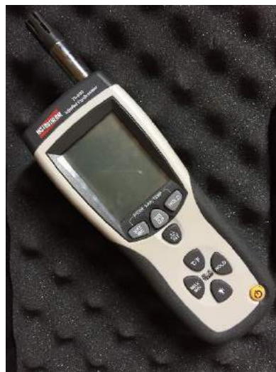
Figura 2 – Psicrômetro infravermelho modelo TI-400
