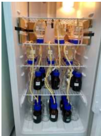
Figura 1. Incubadora onde o teste BMP foi desenvolvido.
