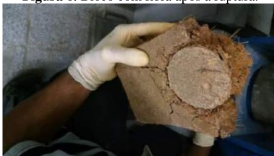
Figura 6. Bloco com fibra após a ruptura.
