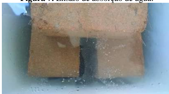
Figura 7. Ensaio de absorção de água.
