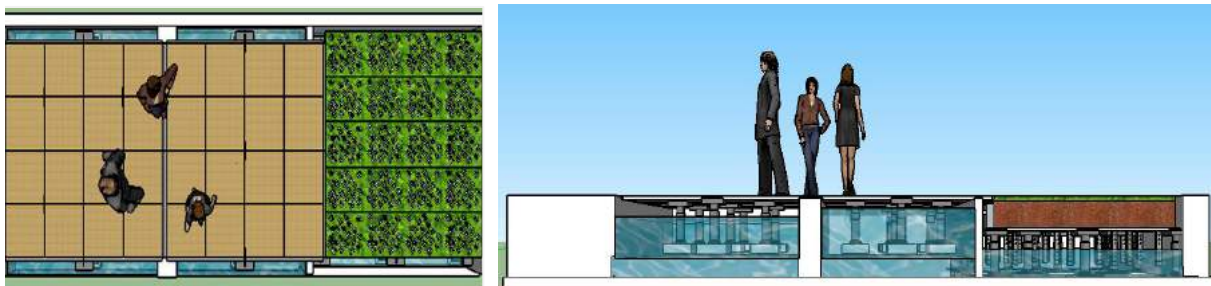
Figura 1. Captação em reservatórios para posterior bombeamento e reuso para manutenção dos jardins e canteiros.
