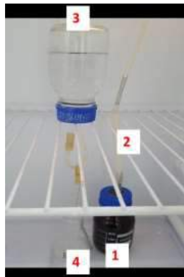
Figura 2. Aparato experimental para o teste BMP.
