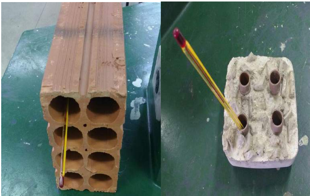
Figura 3. Blocos levados à estufa e aferição de suas respectivas temperaturas
