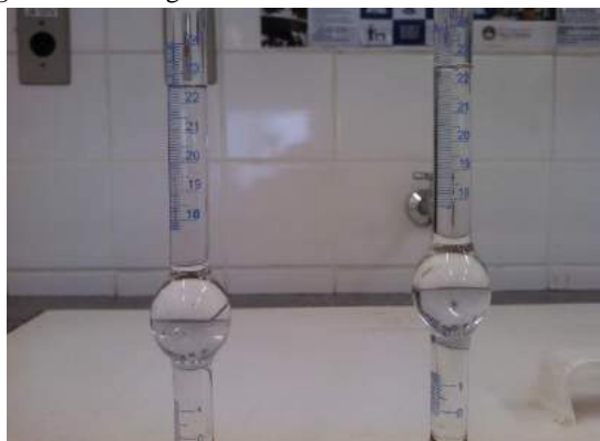
Figura 1. Escala graduada Frasco Le Chatelier com amostra
