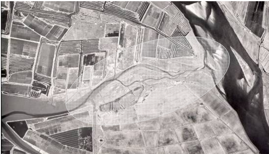
Figura 4.19 – Assoreamento no trecho montante do braço sul do estuário do Mondego
