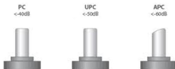
Figura 14 - Tipos de polimento e respetivas perdas de retorno (adaptado de [xiv])
