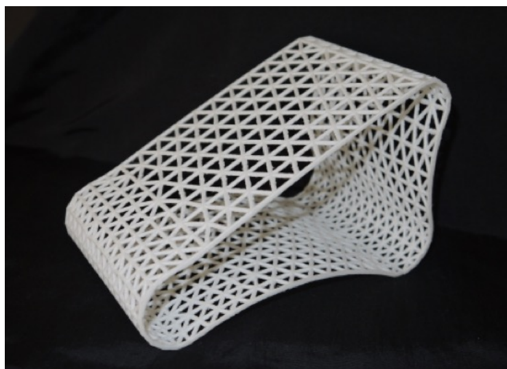
Figura 4. 5. Modelo M4, perfil triangular com densidades diferente
