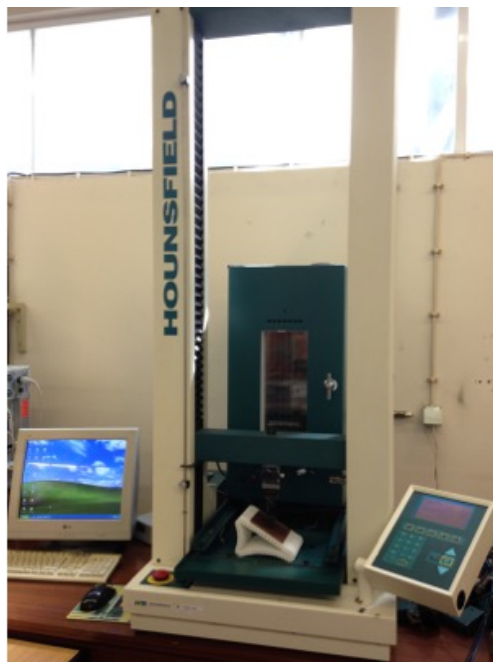
Figura 5. 1. Equipamento dinamômetro Hounsfield H100KS
