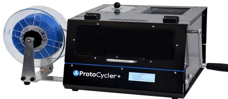
Figura 2. 11. Imagem de equipamento de reciclagem, ProtoCycler (ReDeTec, 2018)
