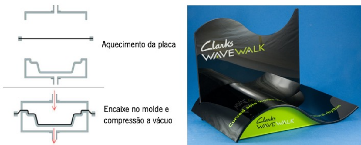
Figura 2. 4. Representação esquemática da deformação térmica de folhas de acrílico e expositor exemplo. (Acrylux, 2018)
