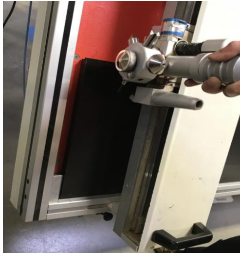
Figura 34 -Controlo do comprimento, largura, esquadria e paralelismo da peça (IKEA Industry, 2018)
