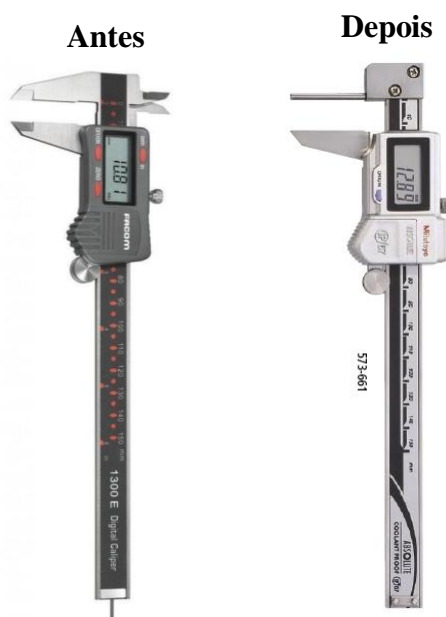
Figura 60 -Paquímetros utilizados para verificar furação
