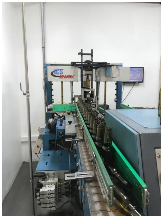
Figura 26- Equipamento da BA mede, mecanicamente, a espessura e diâmetro das garrafas.
