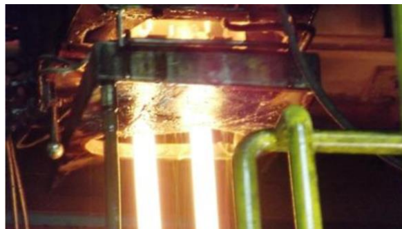
Figura 5- Local de saída da gota para o molde (Azinheira & Dias, 2014).
