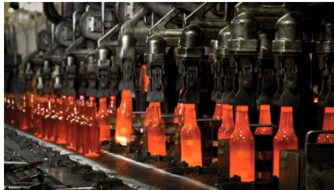
Figura 6- Garrafa a sair do molde (Ferguson, 2017).
