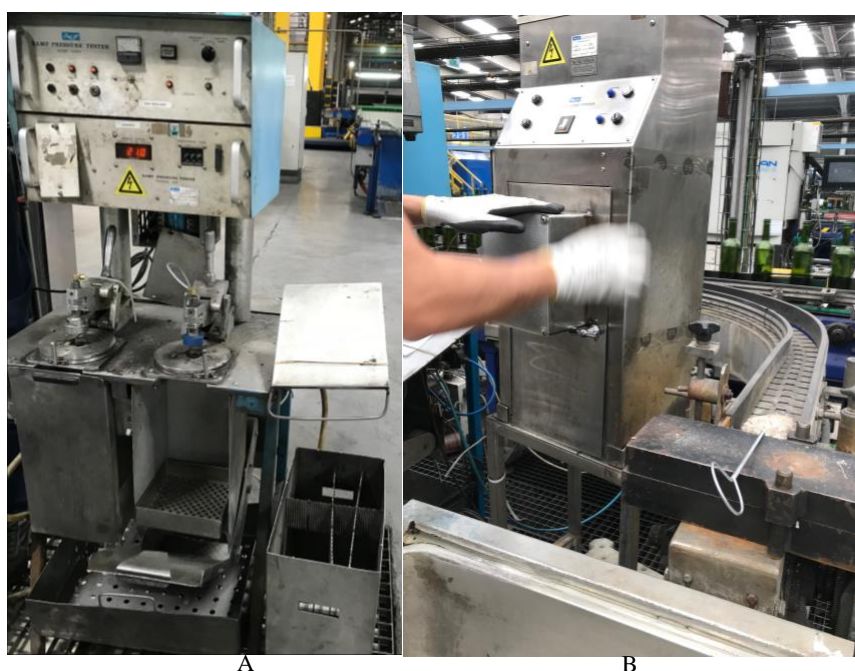
Figura 30: A- Equipamento que mede a pressão interna; B- Equipamento que mede a carga vertical.
