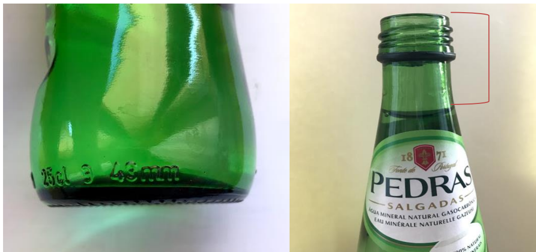
Figura 29: A- Marca dos 43mm na garrafa; B- distância de 43mm, ou inferior.
