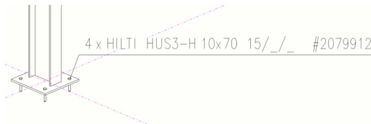
Figura 9: Detalhe em Tekla da ligação calculada
