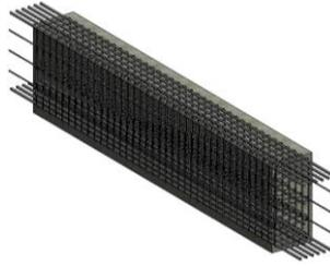
Figura 4: Pormenorização das armaduras de uma Viga de Equilíbrio.
