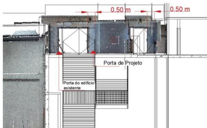
Figura 10: Comparação do alinhamento das portas de emergência da sala do piso superior
