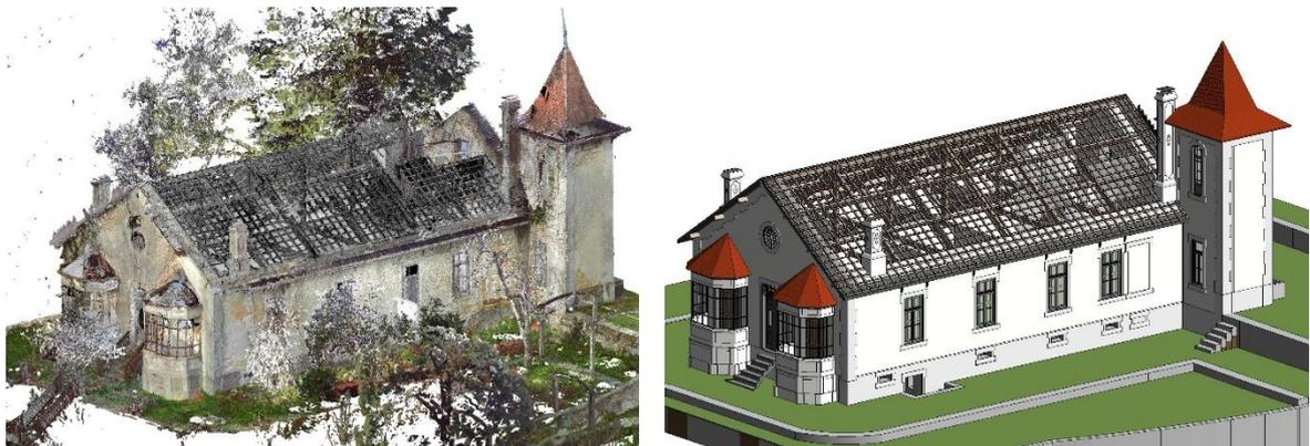
Figura 23: Levantamento laser scanning e modelo BIM do edifício existente.
