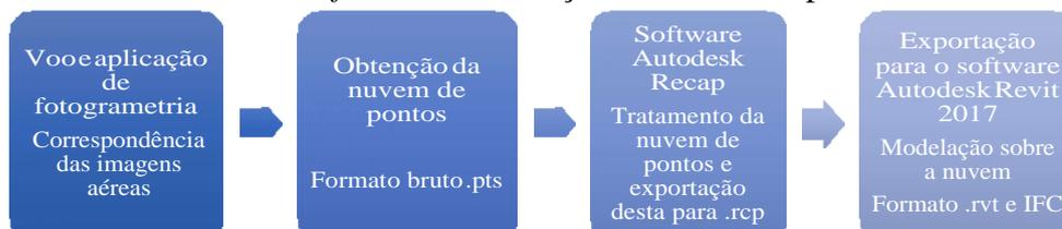
Figura 4: *Workflow* da interoperabilidade entre a fotogrametria e a modelação BIM.
