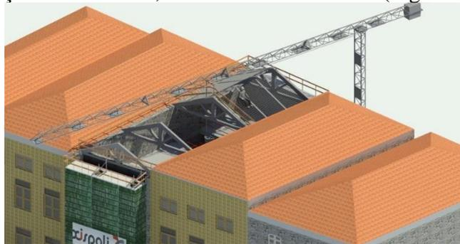
Figura 3: Integração de movimentação de cargas no modelo BIM
