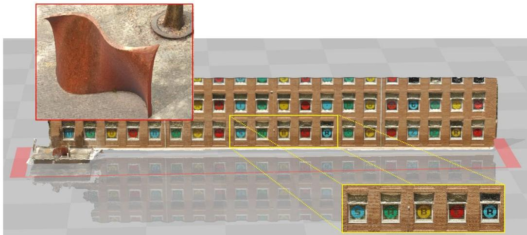
Figura 11: Fotogrametria: fachada de edifício com 60 m de extensão e pormenor arquitetónico
