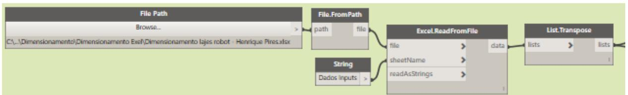
Figura 8 - Rotina em *Dynamo* para importação dos valores do *Excel*.
