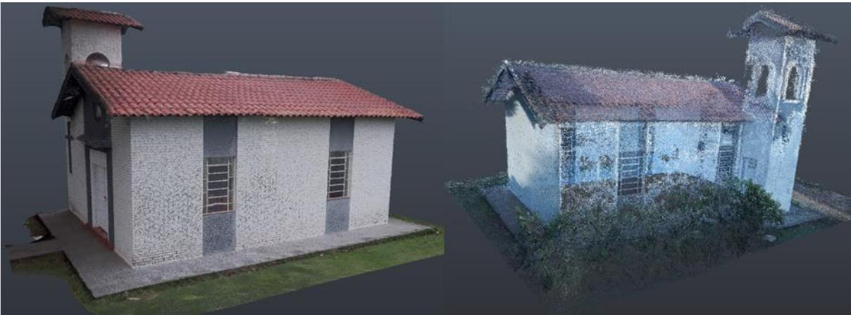
Figura 5: Esquerda: Camera Sony Alpha processada com PIX4D<sup>®</sup> no ambiente de visualização do Recap<sup>®</sup>. Direita: Camera IPHONE SE processada e visualizada no Recap<sup>®</sup>.
