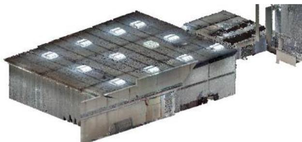
Figura 6: Nuvem de pontos: *Laser scanner* (.rcp)
