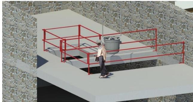
Figura 4: Posicionamento de guarda-corpos
