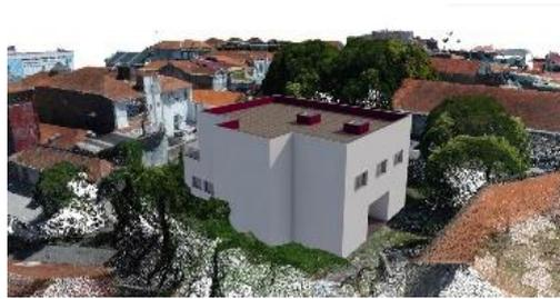
Figura 1 – *Render* fotorrealista com nuvem de pontos (edifício e envolvente)
