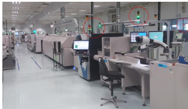
Figura 50 - Torres de Iluminação em SMT
