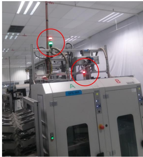
Figura 83 - Alerta luminoso para o abastecimento de material no gap-filler
