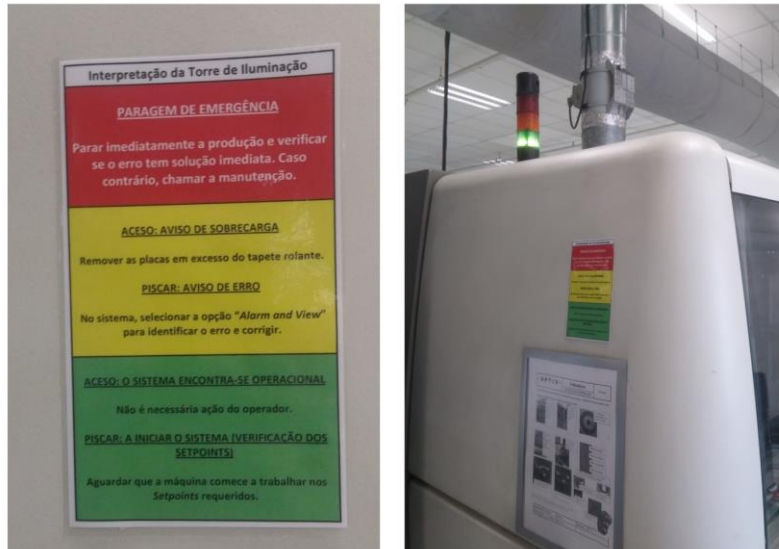
Figura 84 - Legenda da torre de iluminação da máquina de soldadura seletiva
