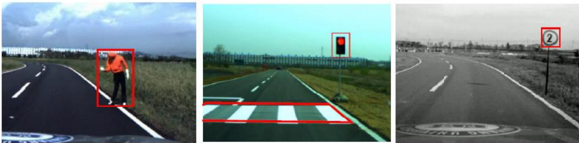
Figura 3 - Deteção e identificação de obstáculos veículo A1, [9]: À esquerda a deteção do passageiro; Ao centro a deteção da passadeira e do semáforo; À direita a deteção do sinal de trânsito.
