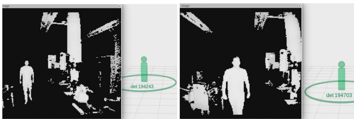
Figura 50- Sequencia de duas imagens de deteção de uma pessoa com a câmara em movimentos aleatórios.
