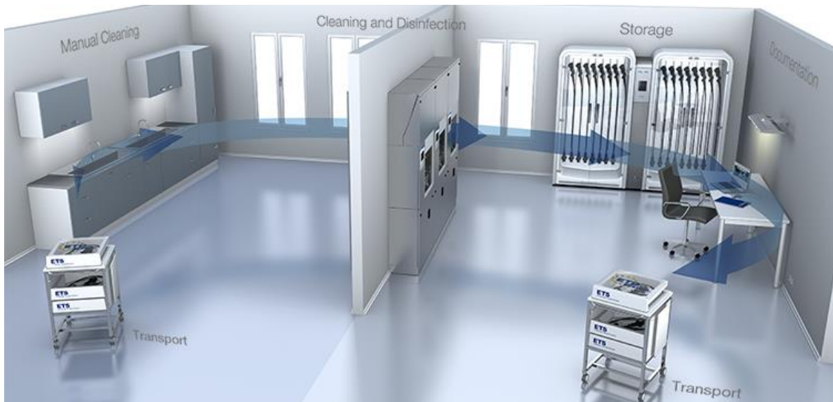
Figura 3 - Cadeia de processos de esterilização de endoscópios [7].
