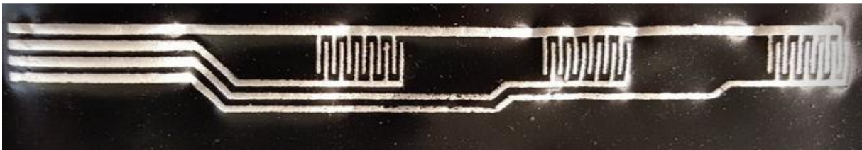
Figura 37 - Exemplo de matriz de sensores piezorresistivos impressos.
