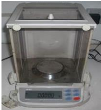
Figura 29 – Balança de precisão AND HR usada para medir as quantidades de solutos.
