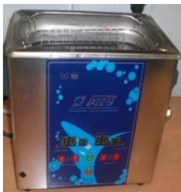
Figura 30 – Equipamento de ultrassons para dispersar do CNT.
