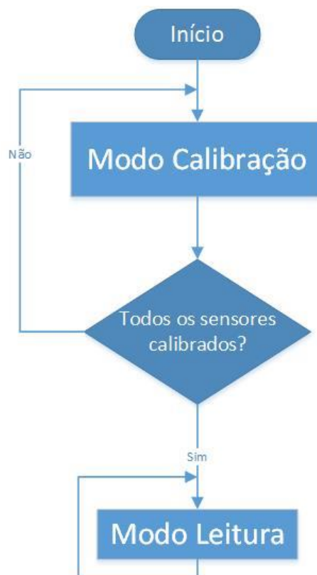
Figura 48 – Fluxograma do comportamento geral do circuito.
