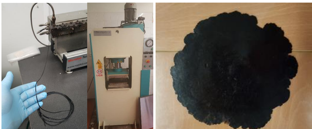
Figura 58 – a) Fio do compósito. b) Pressa hidráulica. c) Resultado após o fio ter saído da máquina de pressão hidráulica.
