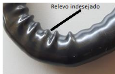
Figura 54 – Relevo indesejado que levou a uma nova projeção da matriz.
