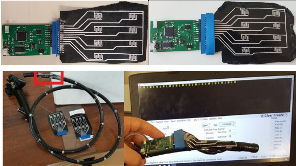
Figura 67 a) Circuito final conectado à matriz impressa no substrato do tipo 2 e b) do tipo 3. c) Matriz instrumentalizada no endoscópio. d) Integração do sistema.
