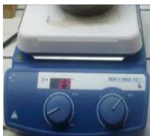
Figura 31 – Agitador magnético para dissolver o SBS.
