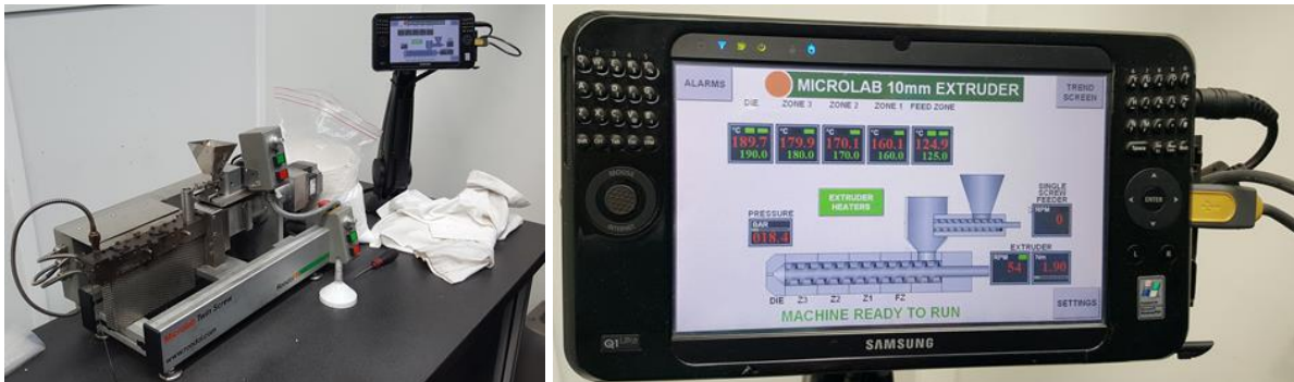
Figura 57 – a) Extrusora da marca Microlab modelo Twin Screw. b) Registo das temperaturas das 5 seções e da velocidade em rotações por minuto.
