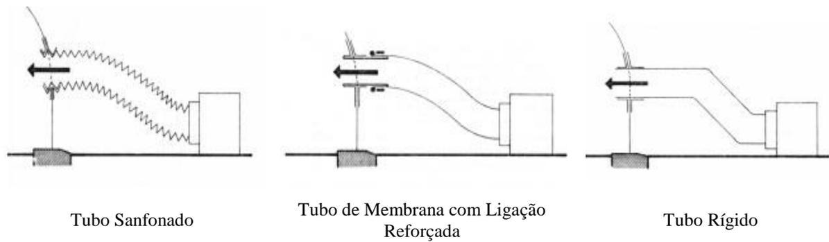
Figura 52: Tipos de tubo para transferência do ar para a estrutura.
