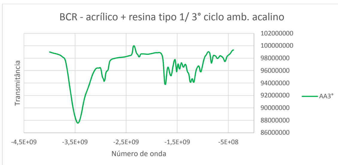
Figura 4-15 - Amostra: acrílico + resina tipo 1 exposto ao ambiente alcalino.
