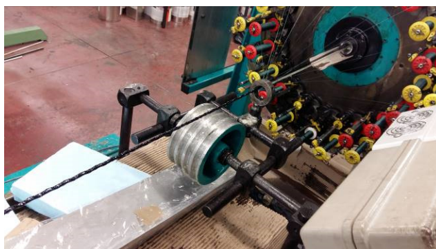
Figura 3-4 - Máquina de entrançamento.
