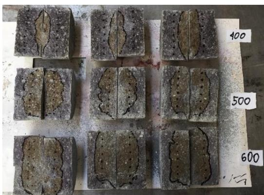
Figura 3.26 – Provetes para medição da profundidade de penetração de cloretos.
