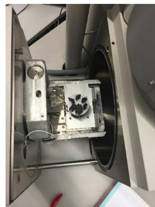
*Figura 3.30 – Amostras revestidas com Au/Pd inseridas no equipamento de MEV.
