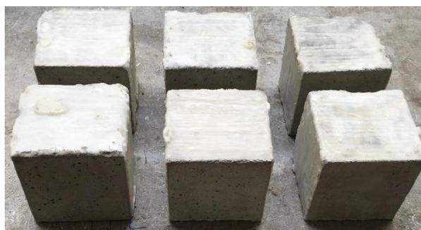
*Figura 3.28 – Provetes impermeabilizados para ensaio de resistência a carbonatação.
