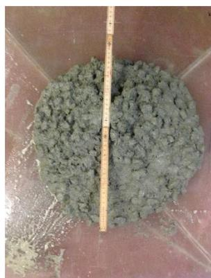
Figura 3.15 – Espalhamento de 380 mm BACED\_500\_2,5%SP com brita 10/20.
