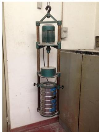
Figura 3.3 – Ensaio de granulometria.
