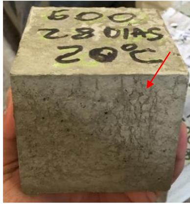
Figura 4.19 – Quadro fissuratório do BACED\_600 devido ao fenômeno de retração.
