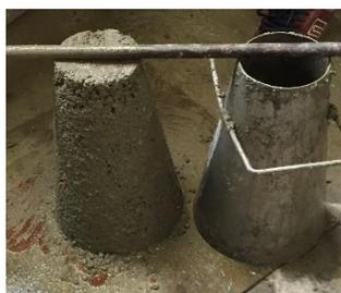
Figura 3.13 – Resultado do ensaio de abaixamento BC\_350 com brita 4/8.
