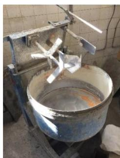
Figura 3.10 – Betoneira de eixo vertical.
