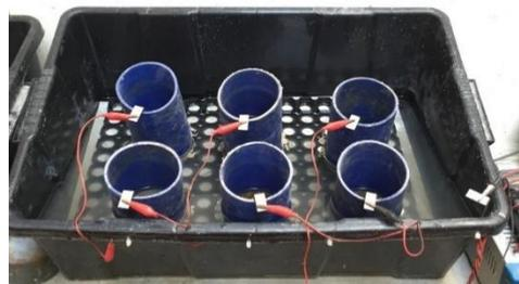
Figura 3.25 – Configuração do ensaio de migração de cloretos.
