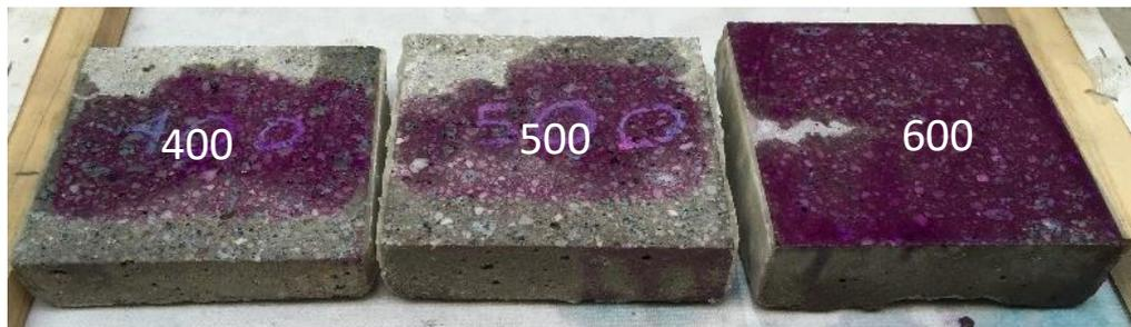
Figura 4.28 – Aferição de profundidade de carbonatação aos 30 dias.
