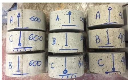
Figura 3.24 – Amostras para ensaio de migração de cloretos.
