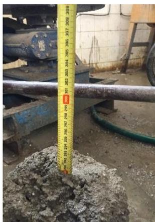
Figura 3.14 – Resultado do ensaio de abaixamento BC\_400.
