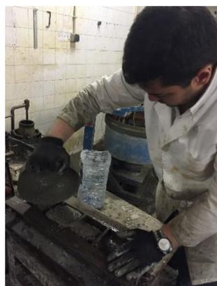
Figura 3.21 – Preenchimento dos moldes cúbicos com BACED\_500\_3%SP.
