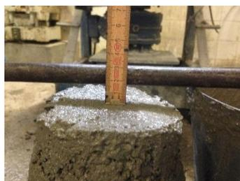
Figura 3.12 – Resultado do ensaio de abaixamento BC\_350 com brita 10/20.
