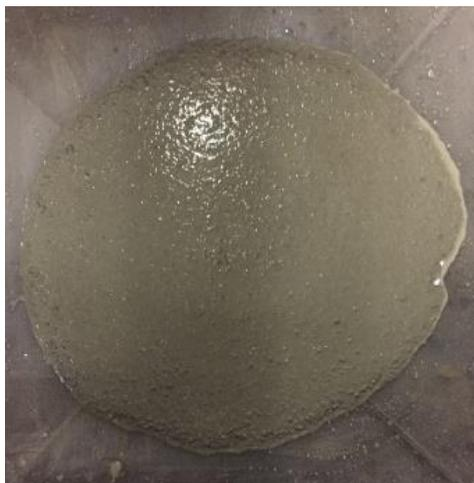
Figura 3.22 – Espalhamento BACED\_600\_3%SP.
