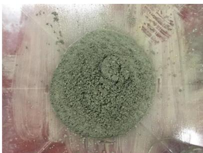
Figura 3.19 – Ensaio de espalhamento BACED\_500\_1,5%SP com 50% de areia natural.
