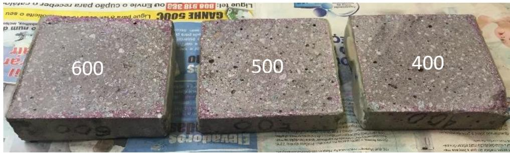
Figura 4.27 – Aferição de profundidade de carbonatação aos 7 dias.
