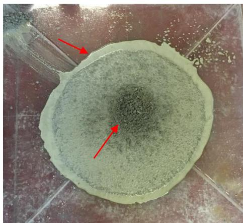
Figura 3.17 – Ensaio de espalhamento BACED\_500\_2,5%SP.
