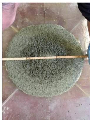
Figura 3.20 – Espalhamento BACED\_500\_3%SP.
