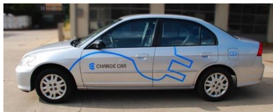
Figura 2.5 – Honda Civic convertido em VE pelo laboratório CREATE Lab do Instituto de Robótica da Universidade de Carnegie [21].
