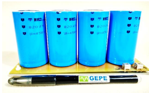
Figura 4.16 – Condensadores do barramento CC.
