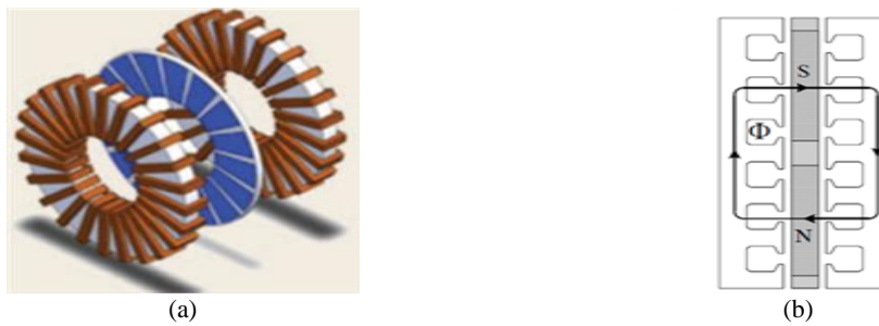
Figura 2.15 - Máquinas double-sided da tipologia AFIR: (a) Constituição do motor; (b) Esquema do tipo slotted [27] [30].
