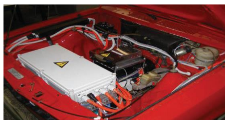
Figura 2.2 – Detalhe do Opel Kadett de 1978 convertido em VE pela Universidade de Zagreb [8].
