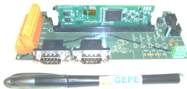
Figura 4.2 - Microcontrolador Delfino TMS320F28335 em versão Card .
