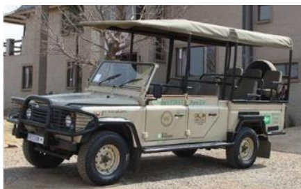
Figura 2.3 – Land Rover Defender convertido em VE pela Freedom Won com equipamento WEG [19].
