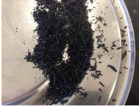
Figura 9 – Borracha de pneu triturado usado na pesquisa. Fonte: Própria autoria, 2013.
