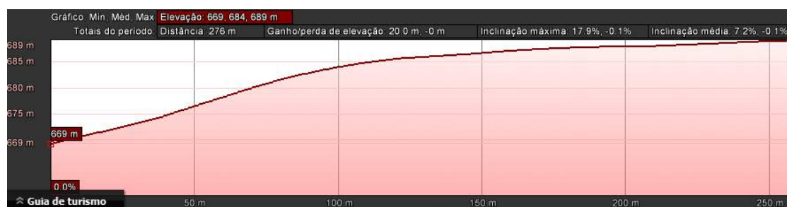
Figura 7 - Inclinação da rua Benjamin Constante. Fonte: Google Earth Pro.
