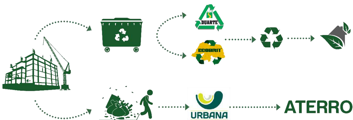
Figura 1. Esquema referente a destinação dos RCD gerados no município em Natal. Fonte: Elaborado pelo autor, 2016
