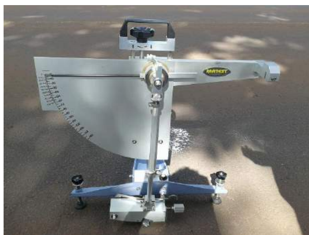
Figura 5 - Execução do ensaio de microtextura com o Pêndulo Britânico.
