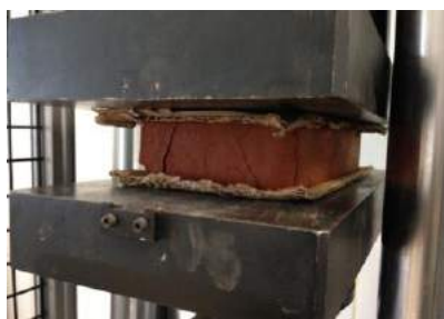
Figura 4. Tijolo em prensa
