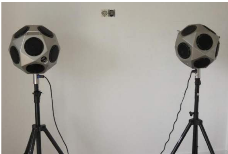
Figura 2. Exemplo da colocação das fontes num compartimento.
