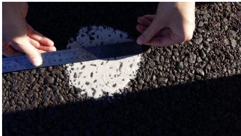
Figura 4 - Ensaio de macrotextura através do método Mancha de Areia.
