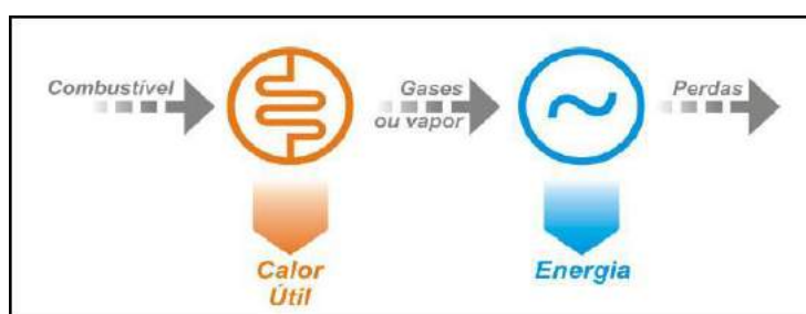
Figura 2. Ciclo tipo Bottoming . Fonte: Barja, 2006.
