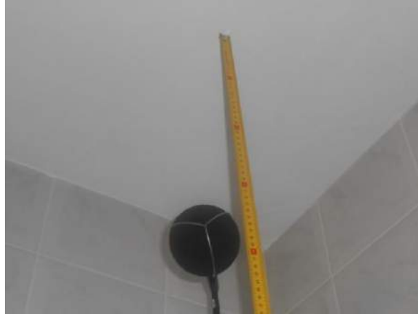
Figura 4. Exemplo da colocação do microfone no canto superior de um compartimento.
