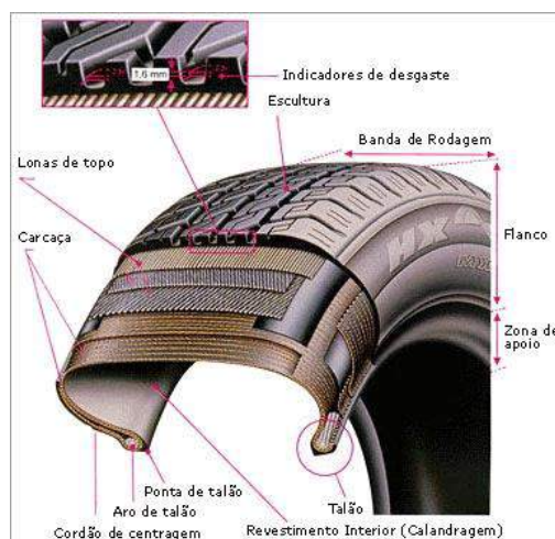
Figura 2 – Estrutura de um Pneu. Fonte: Website Low Cost Pneus, 2013.
