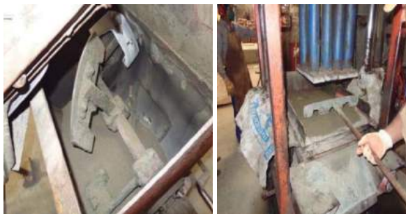
Figura 10. Colocação do agregado seco no misturador. Figura 11. Confeção do paver na prensa.
