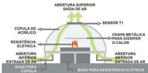
Figura 4: Etapa 3 do experimento prático de ventilação por efeito chaminé. Fonte: Relatório realizado pelos alunos Sandra Feldmann e Wesley Magio.
