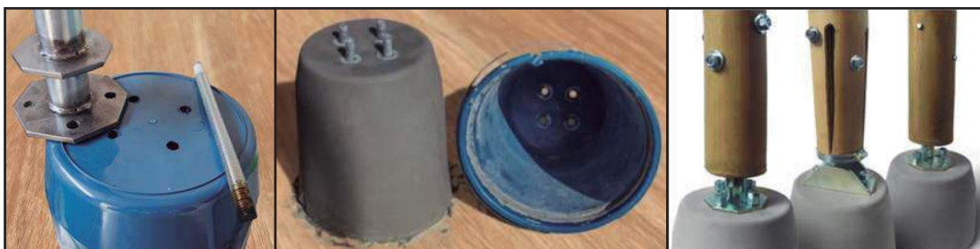
Figura 10. Produção das bases de concreto e protótipos finalizados (Fonte: do autor).
