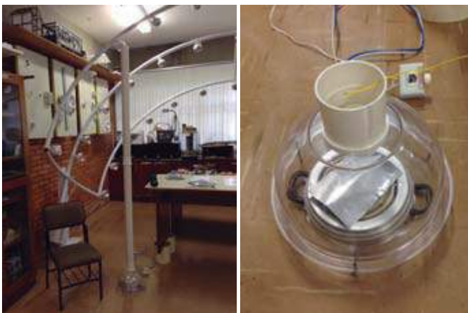
Figura 2: (a) Experimento prático de ventilação por efeito chaminé, (b) Base do experimento prático de ventilação por efeito chaminé. Fonte: acervo pessoal
