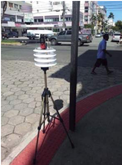
Figura 4. Equipamento completo para monitoramento climático, com destaque para o abrigo confeccionado com pratos de poliestireno expandido.
