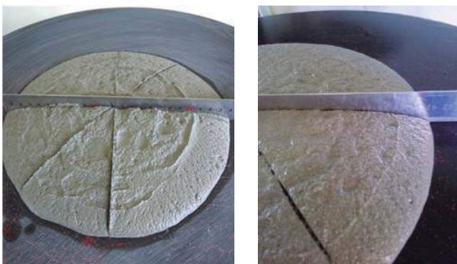
Figuras 2 e 3 – Ensaio de índice de consistência (260mm e 255mm)
