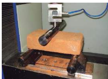
Figura 3. Ensaio de determinação do módulo de ruptura na flexão (MOR)
