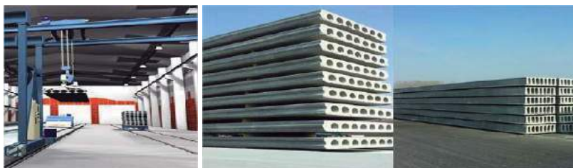
Figura 4. lançamento das LABP (esquerda); Estocagem das LABP (direita) (Fonte: Elematic, 2007; Araújo, 2011)
