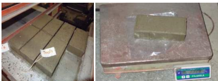
Figura 12. Identificação da produção de cada forma. Figura 13. Medição e pesagem do paver após a fabricação
