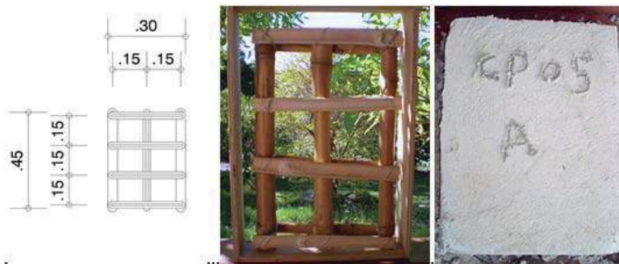
Figura 1 – Entramado e taipa de bambu feita em Mucugê
