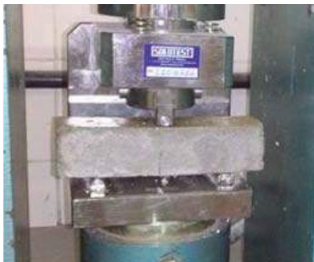
Figura 3: Corpo de prova de argamassa em processo de ruptura.
