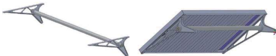
Figura2. Encaixes das Peças para formação do Brise-Soleil , Fotovoltaico Modelo SX 120 U /BP Solar (Referência).
