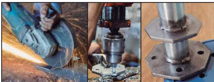
Figura 9. Etapa de usinagem dos componentes da conexão metálica (Fonte: do autor).
