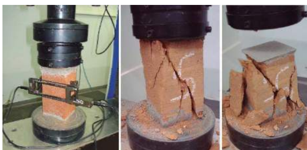
Figura 6. Alguns aspectos dos ensaios de determinação do módulo de deformação, notando-se o dispositivo de medição de deformações (extensômetros eletrônicos EMIC) e o padrão de ruptura dos CPs
