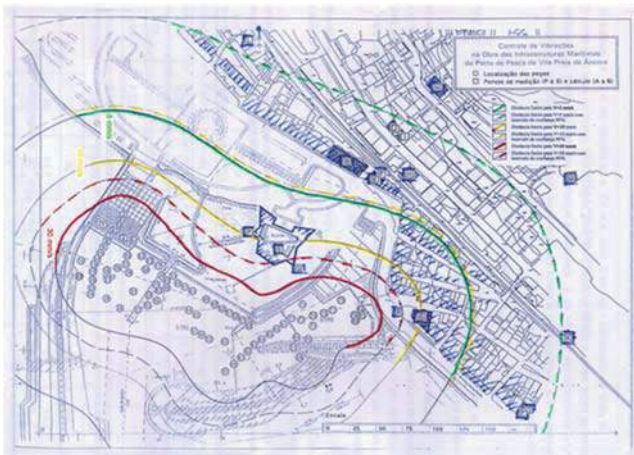
Figura 4.3 – Mapa de vibração: Planta do local da obra de escavação com explosivos, com a localização das pegas, O, dos pontos de medição, P a S, e locais de reclamação, A a M, □, e as isocinéticas correspondendo a d(v_{adm}) , — — — e a d(v_{adm}/(1+3\sigma)) — — — .
