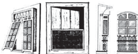
Figura 10: Gelosia com rótula. Fonte: Mascarello (1985). Figura 11: Janela com urupema. Fonte: Mascarello (1985). Figura 12: Gelosia com muxarabi. Fonte: Mascarello (1985).
