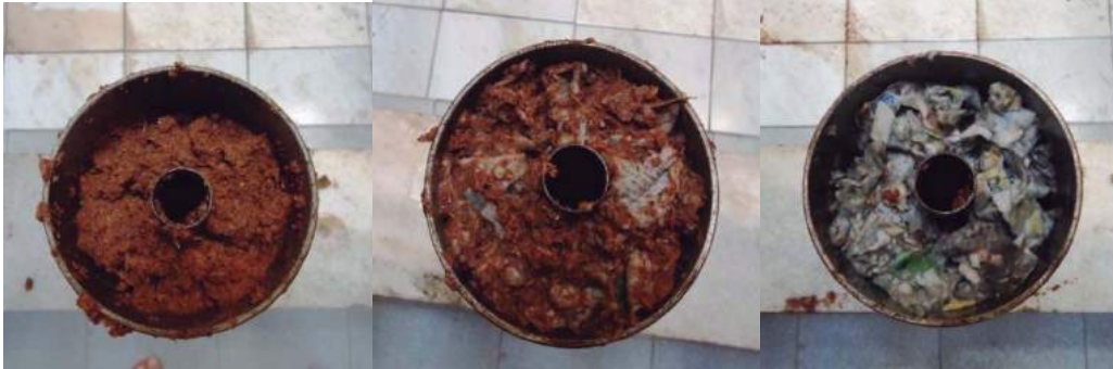
Figura 3. Material de jornal, serragem com aglutinante e serragem com jornal, respectivamente, colocados no molde.
