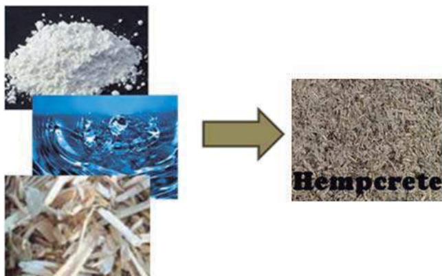
Figura 2 – Constituição do hempcrete
