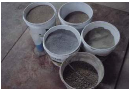
Figura 9. Agregados acomodados para a colocação no misturador.
