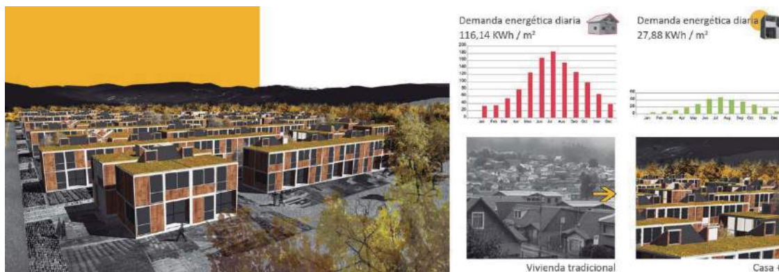
Fig.2: Imagen global de la propuesta, y comparación de demanda energética de una vivienda habitual y de la vivienda CASA+.
