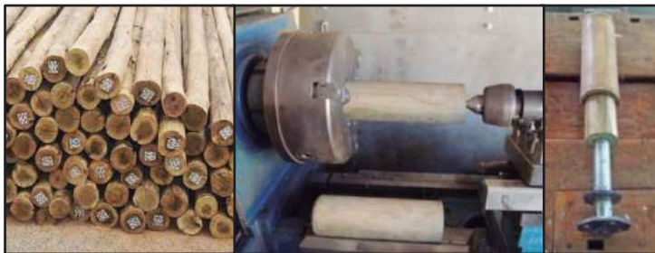
Figura 8 – Processamento das peças roliças de madeira (Fonte: do autor).
