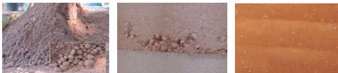
mistura heterogênea mistura com grumos compactada tufo de microfibras de polipropileno Figura 7. Aparência da mistura utilizada para a produção das paredes de taipa.
