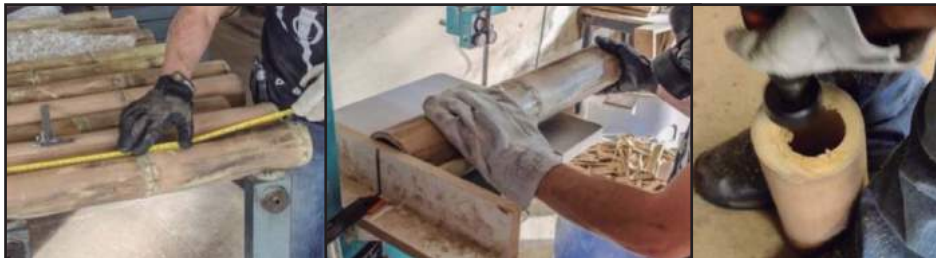
Figura 7. Processamento das peças de bambu in natura (Fonte: do autor).
