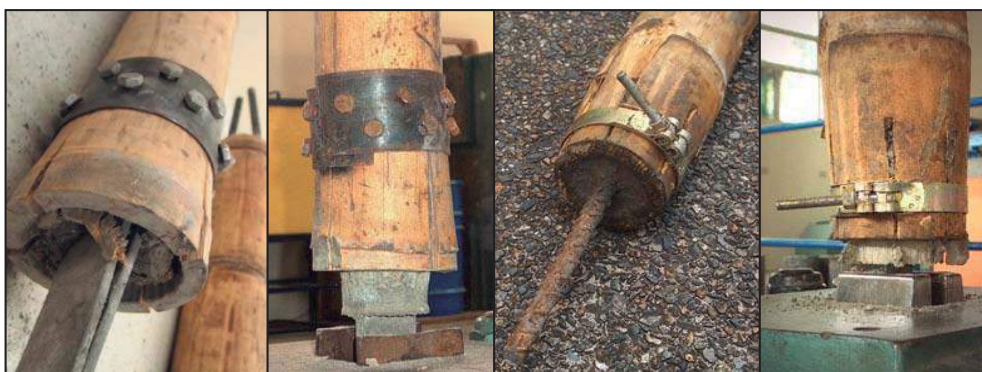
Figura 3. Protótipos de conexões com bambu (Fonte: TÖNGES, 2002).
