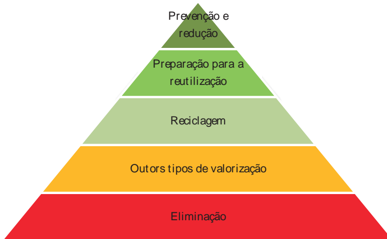
Figura 1 – Hierarquia da gestão de resíduos de demolição e construção (Produzido pelo Autor).
