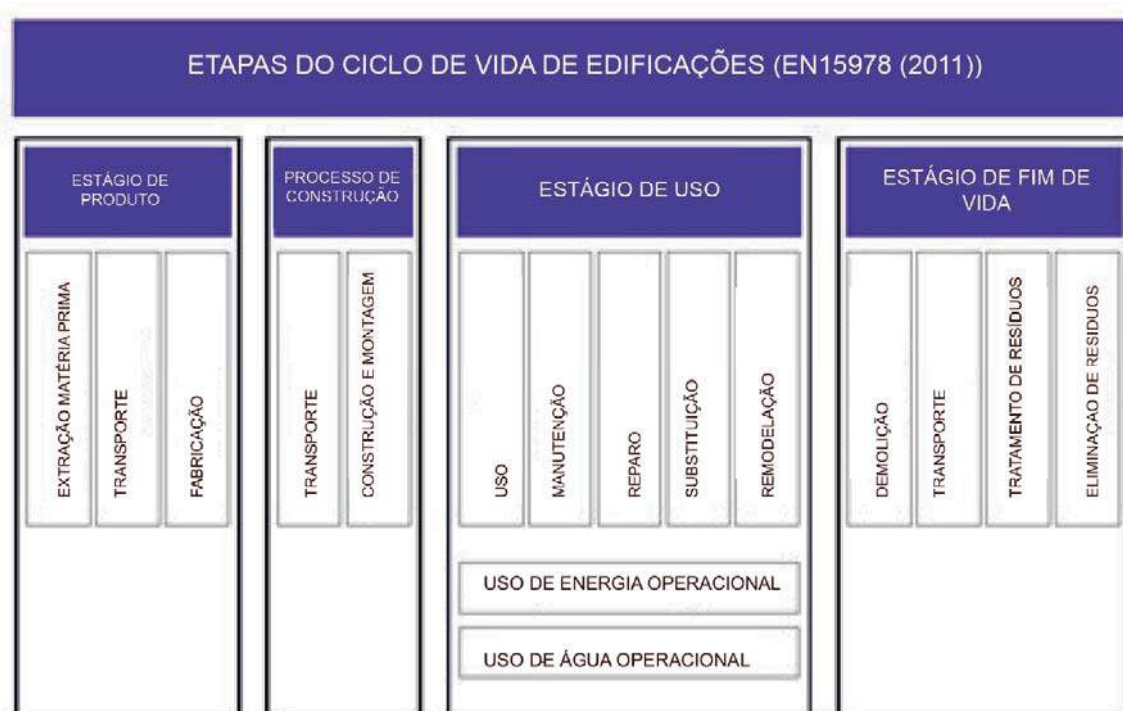
Figura 2. Estágios do ciclo de vida completo de edificações, segundo a norma EN15978 (2011)). (Adaptado de GOMES et al., 2014).
