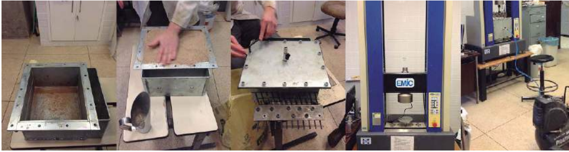
Figura 2. Passos para realização do ensaio de arrancamento
