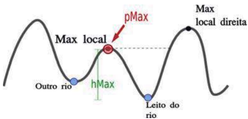
Figura 2. Para este caso o máximo à esquerda é também o pMax . Ele é menor que o máximo à direita. A maior altura possível para o posicionamento de uma barragem neste ponto do leito do rio é o hMax .
