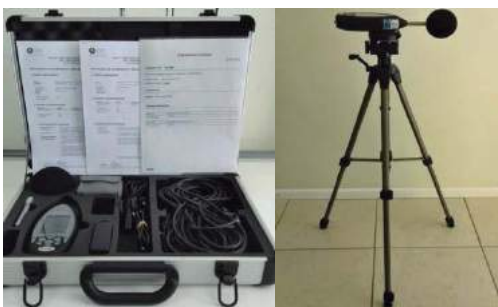
Figuras 13 e 14: Equipamento utilizado: sonômetro, calibrador, microfone e tripé. Autor: Leonardo Romitti
