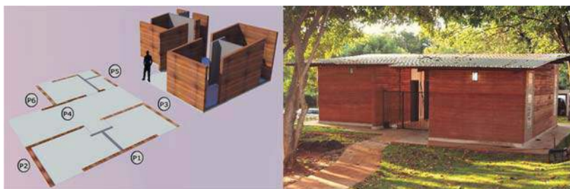
Figura 1. Ordem de execução das paredes do protótipo de habitação.
