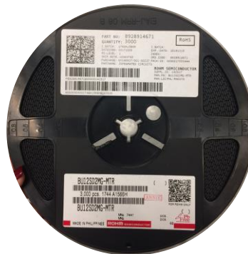
Figura 58. MAT-Label anexada à bobine
