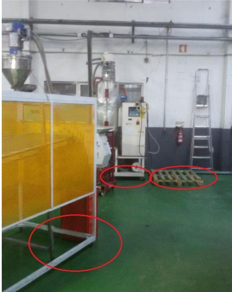
*Figura 35 - Falta de marcação para os elementos periféricos*
