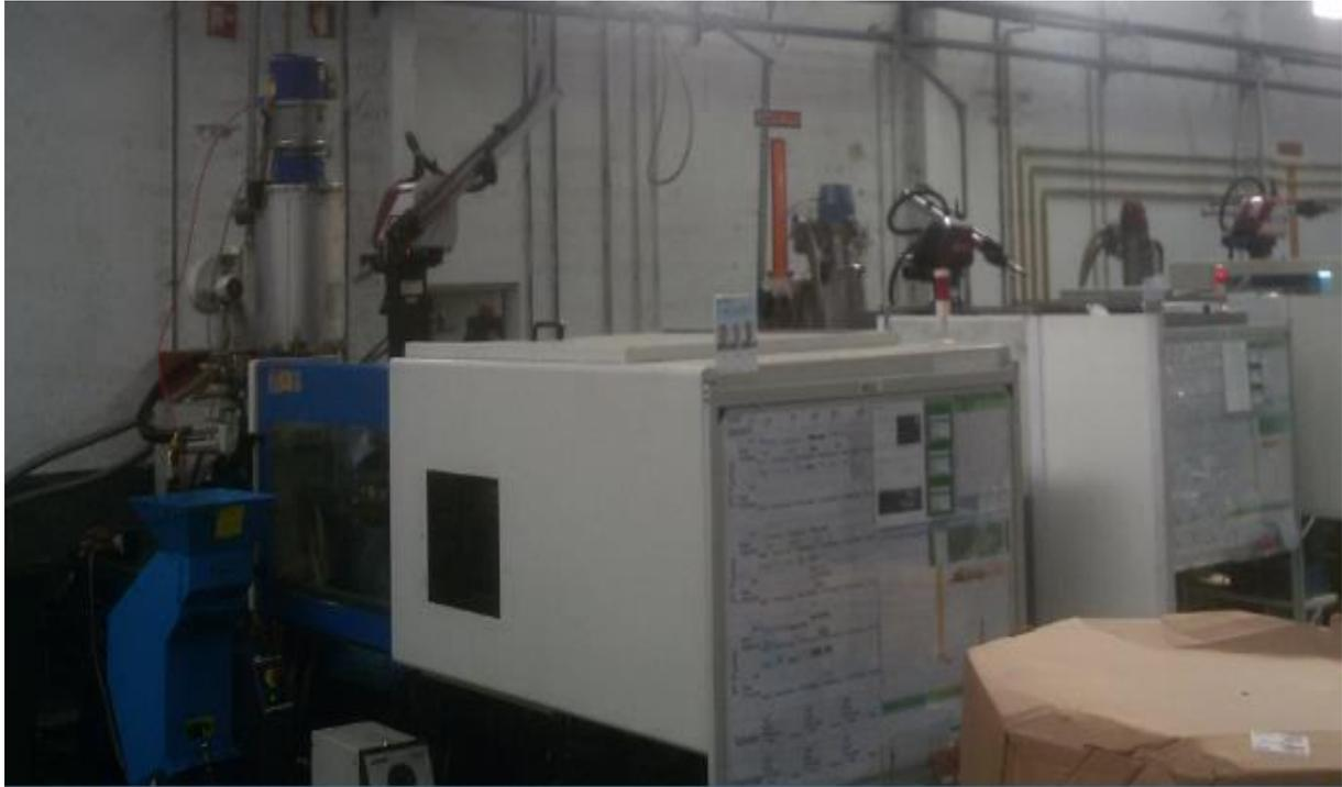
*Figura 18 - Máquina de injeção (COPEFI)*
