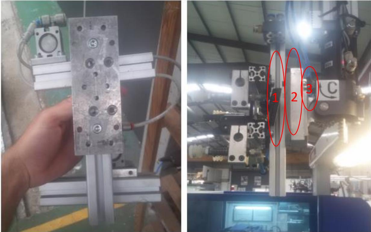
Figura 30 - Exemplo de Mão de Robot antes e após a montagem
