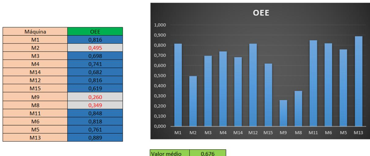
Figura 20 – Resultado do Cálculo do OEE global e por máquina
