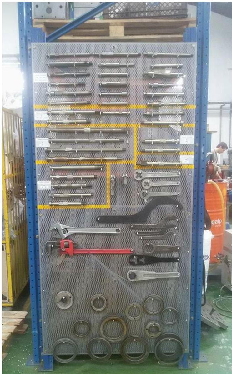
*Figura 53 - Painel com ferramentas de apoio organizado*
