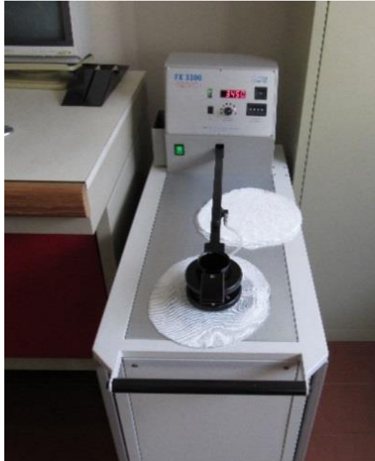
Figura 3.15: Aparelho para ensaio de permeabilidade ao ar FX 3300 da Textest AG, Suíça.
