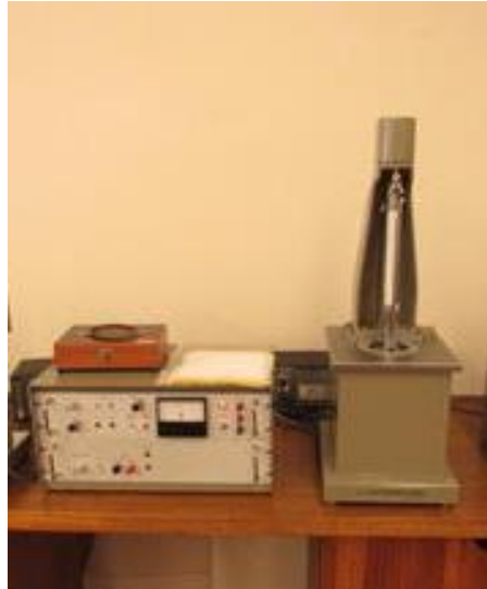
Figura 3.10: Sistema de avaliação FB Kawabata (KES-FB) – módulo de rigidez a flexão.
