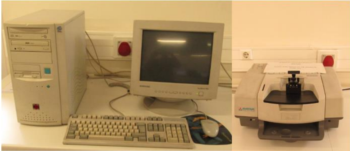
Figura 3.8: Espectrofotómetro (ATR-FTIR) (AVATAR TM 360).
