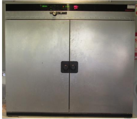
Figura 3.20: Estufa utilizada na avaliação da propriedade de evaporação de líquido.
