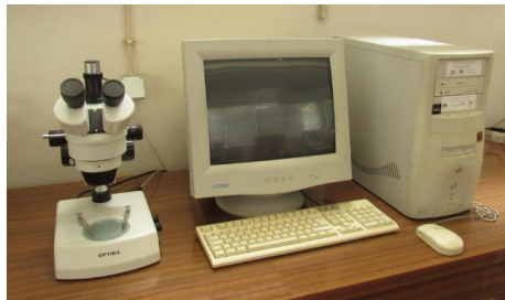
Figura 3.23 : Microscopia óptica - lupa estereoscópica com objetiva 60x
