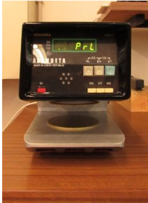
Figura 3.14: Aparelho Alambeta – medição das propriedades de conforto térmico.
