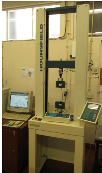
Figura 3.13: Aparelho Dinamómetro utilizado para a medição da resistência a rotura.
