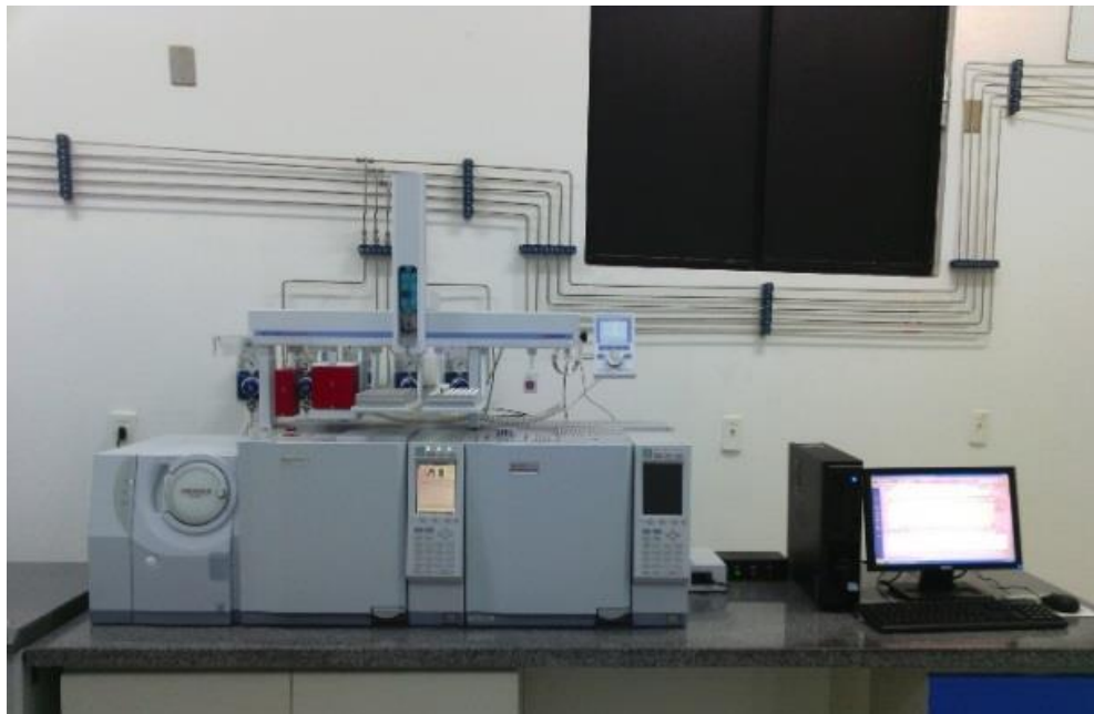
Figura 3.7: Sistema de Cromatografia de Gás Multidimensional, MDGC / GCMS-2010 SHIMADZU.
