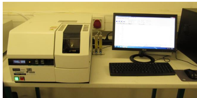
Figura 3.21: Analisador termogravimétrico SAT (TGA) HITACHI STA7200.
