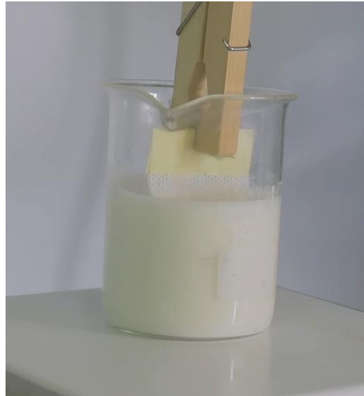
Figura 3.6: Revestimento do material têxtil com gel de quitosano incorporado com nanopartículas de óleo essencial de Copaífera multijuga Hayne.
