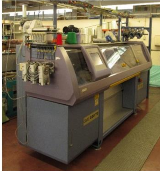
Figura 3.5: Equipamento tear retilíneo eletrônico da marca STOLL, modelo CMS 320 TC.
