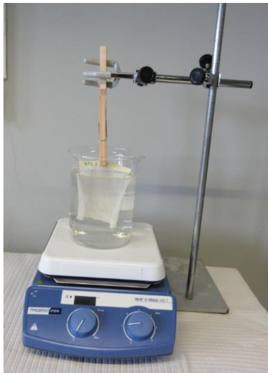
Figura 3.2: Procedimento de imersão utilizado para revestir os materiais têxteis com gel de quitosano.
