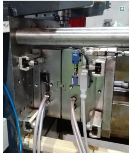
Figura 50- Molde na injetora. (1)- Lado do operador; (2)- Lado oposto ao operador.
