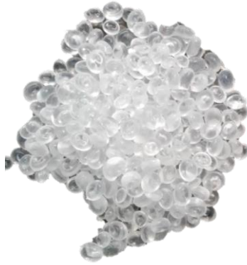
Figura 47- Amostra do copolímero de acetato-vinilo de etileno (EVA).
