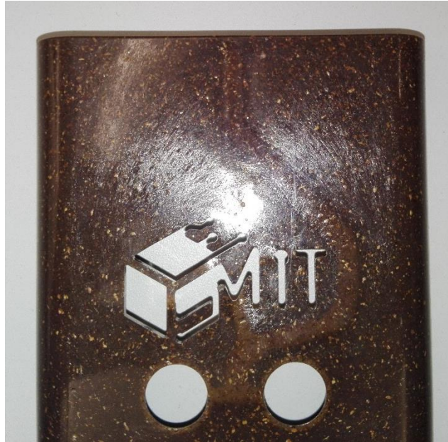
Figura 75- Linhas de fluxo nas peças de CPC.
