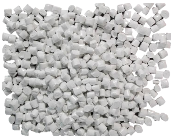
Figura 39- Amostra do acrilonitrilo-butadieno-estireno (ABS).
