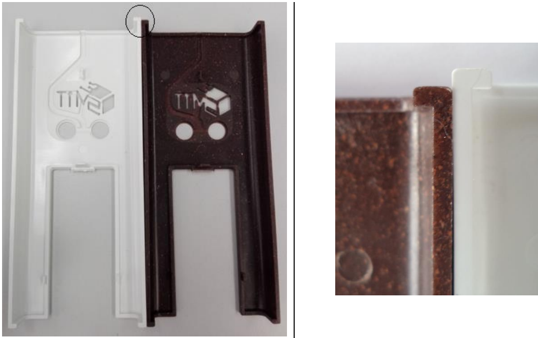
Figura 76- Diferenças na contração das peças.
