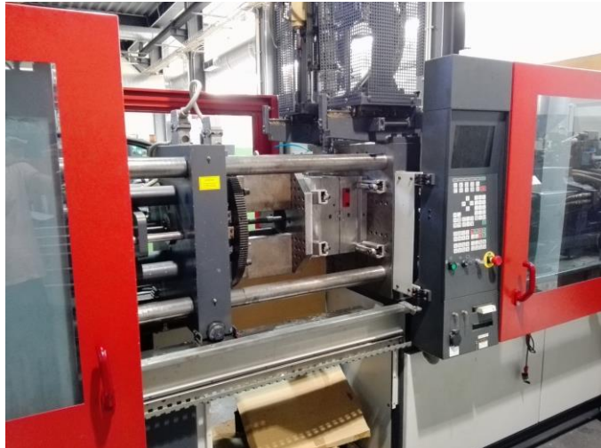
Figura 50- Molde na injetora. (1)- Lado do operador; (2)- Lado oposto ao operador.
