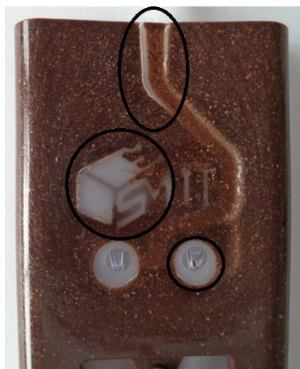
Figura 78- Problemas verificados nas peças bi-injetadas.
