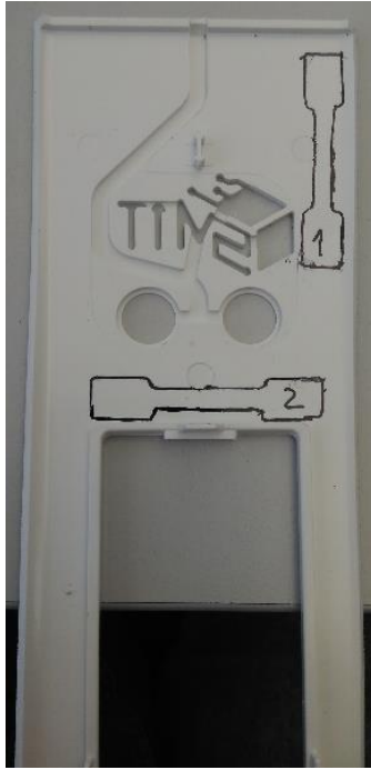
Figura 86- Identificação dos provetes alvo de estudo numa peça de ABS.
