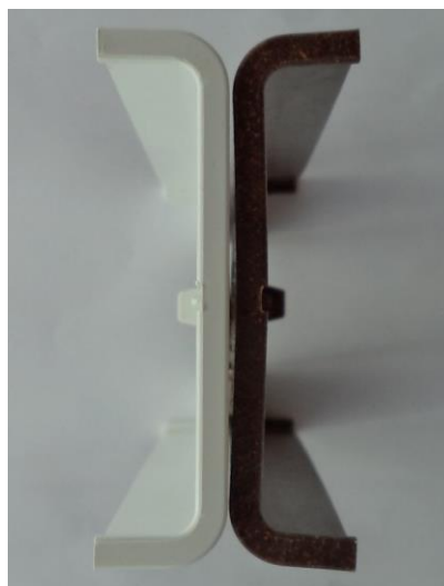
Figura 77- Efeito do empeno nas peças de CPC.
