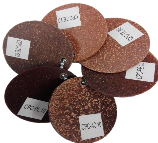
Figura 41- Grades disponíveis comercialmente de compostos de polímero-cortiça.
