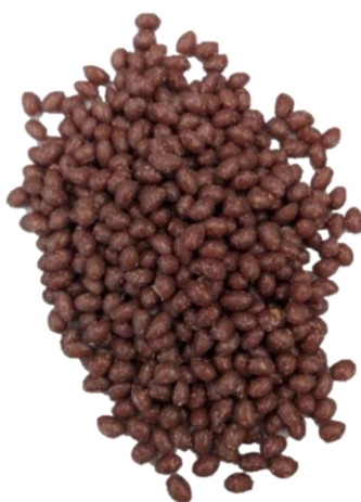
Figura 42- Amostra do compósito de polímero-cortiça.
