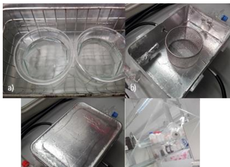
Figura 7 - Figura 7 - Processo de limpeza do substrato: a) imersão no banho ultrassônico em detergente/água destilada e etanol, b) câmara ultravioleta com fluxo de \text{N}_2 aberta, c) câmara ultravioleta com fluxo de \text{N}_2 , d) substrato após processo de limpeza.
