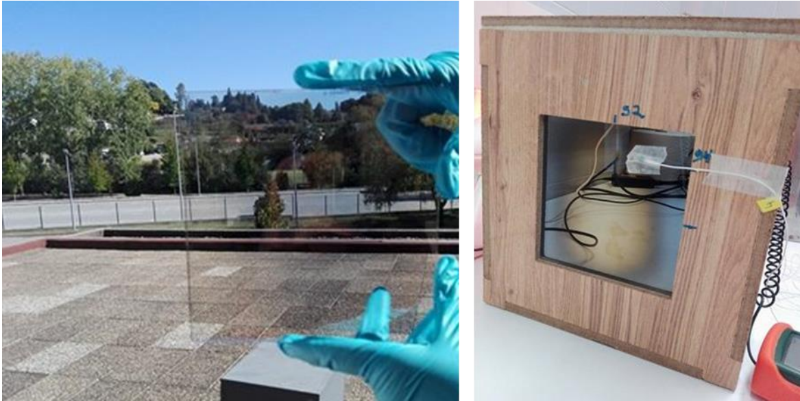
Figura 69 - Amostra de \text{TiO}_2 + \text{Al} + \text{TiO}_2 obtida no dia 27.09.2017 por deposição Sputtering em substrato de vidro de 15 x 15 cm. Colocação da amostra na caixa de avaliação de conforto térmico.
