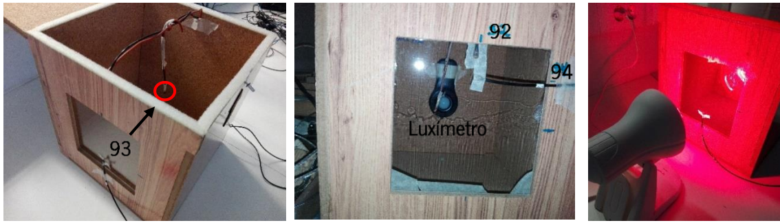
Figura 16 - Caixa de desempenho térmico com respetivos termopares T92, T93 e T94, colocados em locais estratégicos, e fluxímetro para medição da intensidade de radiação da lâmpada IR.
