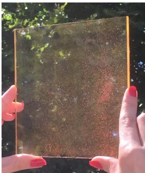
Figura 25 - Protótipo do vidro ultraclear 15 x 15 cm 2 para montagem com as células de silício monocristalino.
