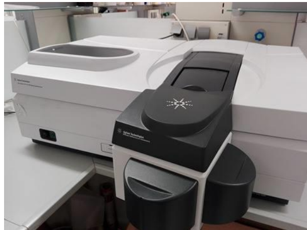
Figura 9 - Espectrofotômetro UV-Vis NIR Cary 5000 da Agilent com esfera integradora Labsphere RSA-PE-20 , disponível nas instalações do CeNTI.
