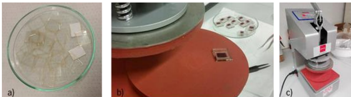
Figura 21 - a) Filme polimérico de selagem após corte a laser; b) caixilho de selagem entre os 2 eléctodos na prensa; c) prensa laboratorial.
