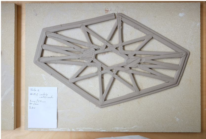
Figura 6.18. Teste de impressão 2 - Peça 19, ponta extrusora de 8mm. Após cura à temperatura ambiente.
