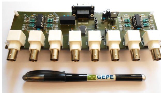
Figura 5.28 – Placa de DAC utilizada no protótipo desenvolvido.
