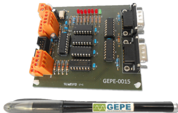
Figura 5.26 – Placa de comando utilizada no protótipo desenvolvido.
