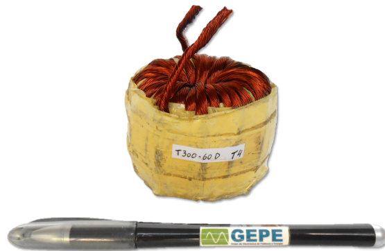
Figura 5.9 – Bobina usada no conversor CC-CC.
