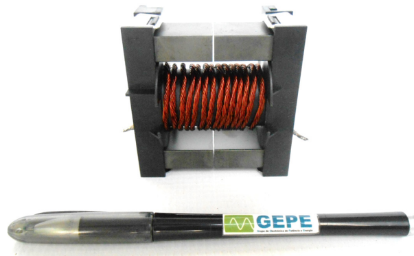
Figura 5.16 – Bobina com núcleo de ferrite usada no filtro passa-baixo à saída do inversor.
