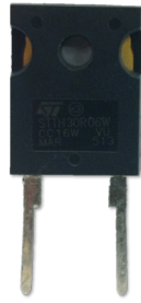
Figura 5.7 – Díodo STTH 3012 da STMicroelectronics usado no conversor CC-CC.
