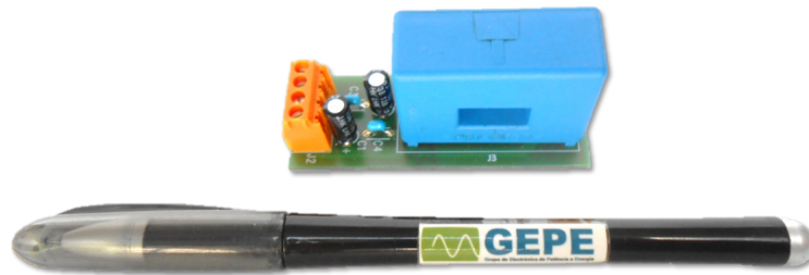
Figura 5.24 – Placa do sensor de corrente utilizada no protótipo desenvolvido.
