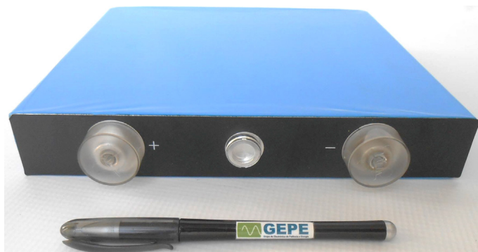
Figura 2.8 – Exemplo de uma bateria de Iões de Lítio ( \text{LiFePO}_4 ) existente no GEPE.
