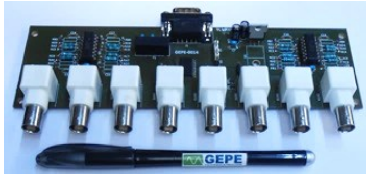
Figura 5.31 - Placa de circuito impresso com o conversor digital analógico.
