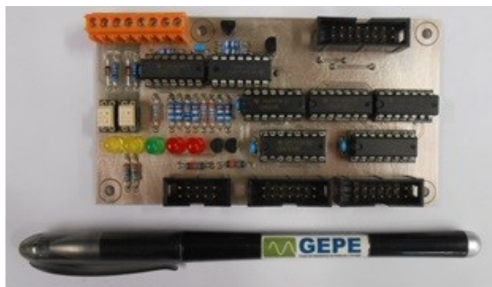
Figura 5.33 - Aspecto final da placa de circuito impresso desenvolvida para comando.
