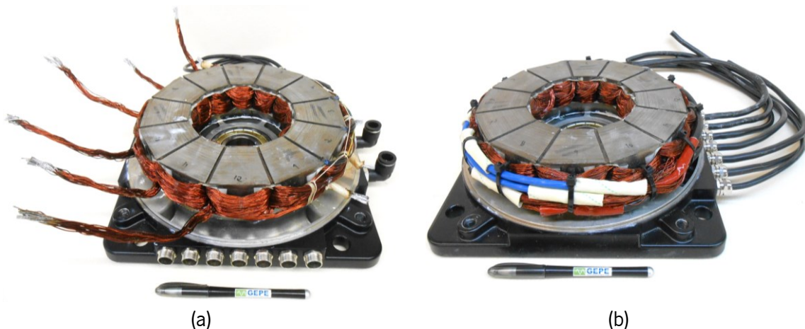
Figura 5.6 - Alteração das ligações internas da máquina elétrica (num dos estatores): (a) Acesso a todos os terminais dos enrolamentos; (b) Aspeto final após amarração.
