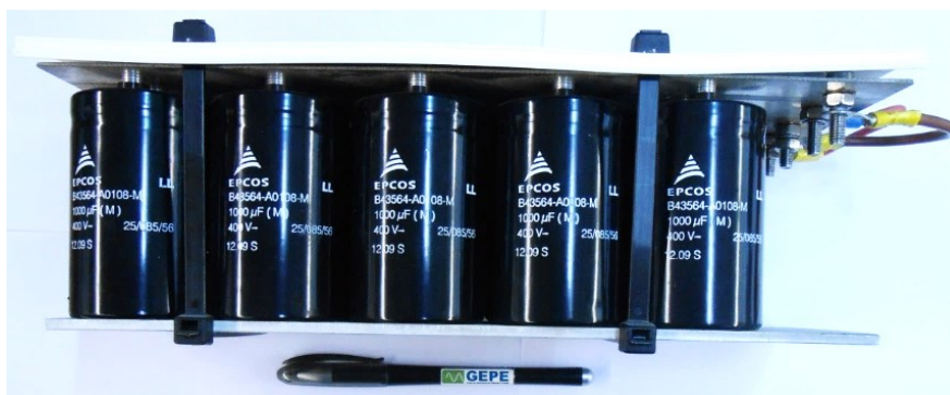
Figura 5.14 – Aspeto final dos condensadores do barramento CC.
