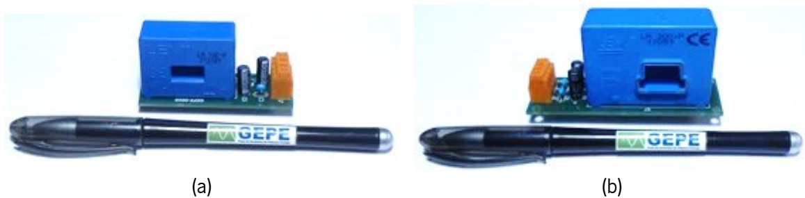
Figura 5.25 - Aspeto final das placas de circuito impresso desenvolvidas para os sensores de corrente da LEM: (a) LA 100-P, (b) LA 200-P.
