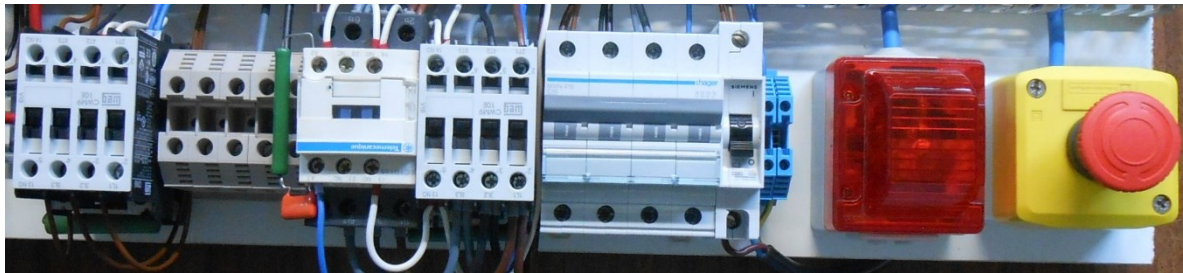
Figura 5.37 - Contactores, disjuntores, lâmpada sinalizadora e botão de emergência no protótipo desenvolvido.
