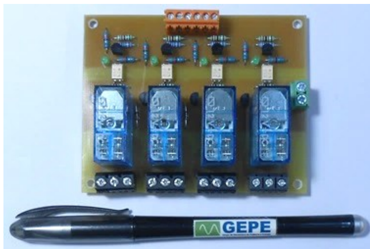
Figura 5.34 - Aspeto final da placa de relés.
