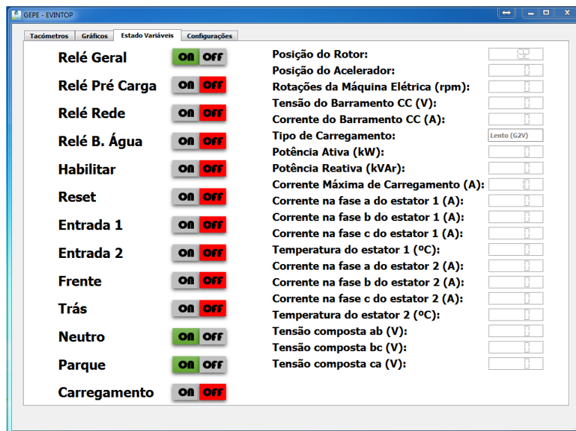
Figura 5.42 - Separador “Estado Variáveis” da aplicação gráfica desenvolvida em Qt.
