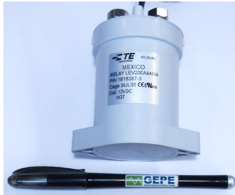
Figura 5.38 - Contactor do barramento CC.
