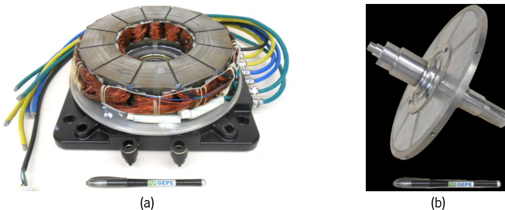
Figura 5.2 - Máquina elétrica escolhida: (a) Aspeto inicial de um dos estatores; (b) Rotor.
