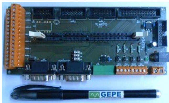
Figura 5.22 - Aspeto final da placa de circuito impresso desenvolvida para a interface entre a placa de controlo TMDSCNCD28335 e os restantes circuitos.
