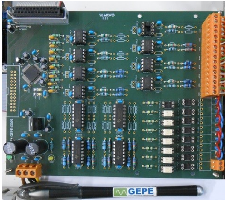
Figura 5.32 - Aspeto final da placa de circuito impresso desenvolvida para o condicionamento de sinal.
