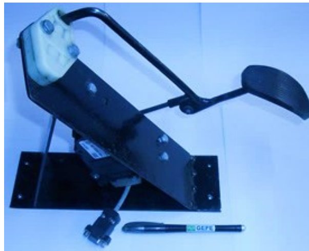
Figura 5.30 - Aspeto final do acelerador eletrónico utilizado.
