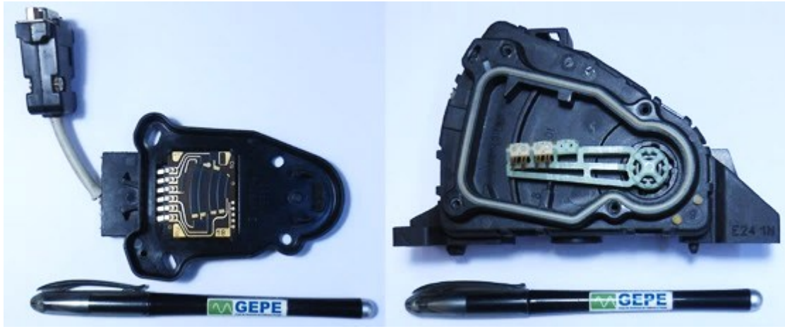
Figura 5.29 - Interior do acelerador eletrónico utilizado.
