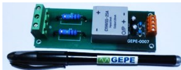
Figura 5.23 - Aspeto final da placa de circuito impresso desenvolvida para os sensores de tensão CYHVS5-25A da ChenYang Technologies .
