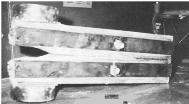
Figura 4: Provete argamassa/resina epoxídica com reforço exterior.
