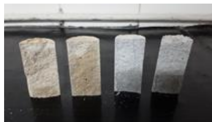
Figura 17: Visualização da ascensão capilar
