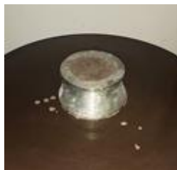
Figura 12: Molde preenchido com argamassa
