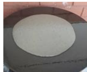
Figura 13: Argamassa após espalhamento
