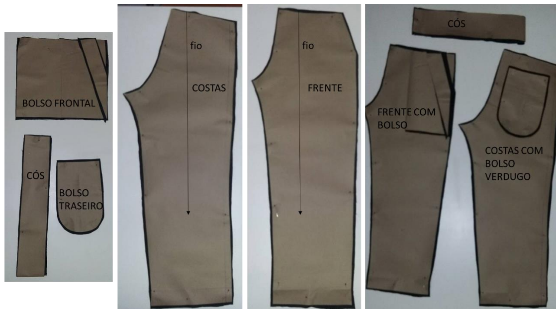
Figura 4.26: Corte do tecido da calça masculina sob o molde. Fonte: Fotos do autor.
