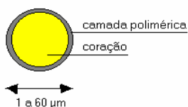
Figura 1 : Estrutura de uma microcápsula.
