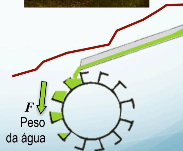
Fig. 1.1 - Imagem e esquema de um moinho de água tradicional
