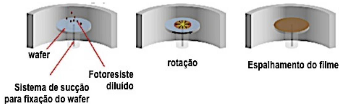
> A espessura final do filme depositado depende de diversos parâmetros, entre eles: a viscosidade da solução, a velocidade e tempo de rotação do spinner.
