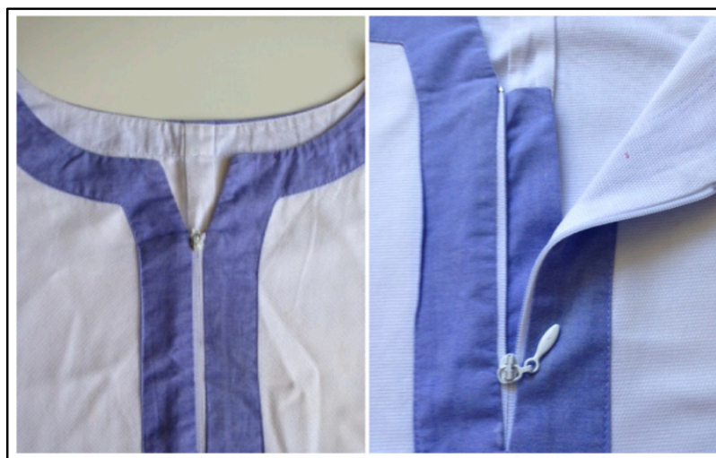
Figura 29 – Revel de acabamento externo e tira dupla de proteção interna do fecho de correr – pertingal.
