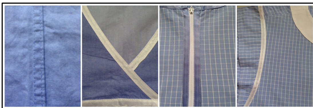
Figura 28 – Costuras e acabamentos utilizados nos modelos (viés de cetim e tiras de tecidos).
