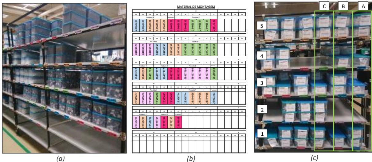
Figura 66 a) Armazenamento após implementação da técnica 5S's; b) Mapa visual de localização de material; c) Estante com posições e níveis atribuídos
