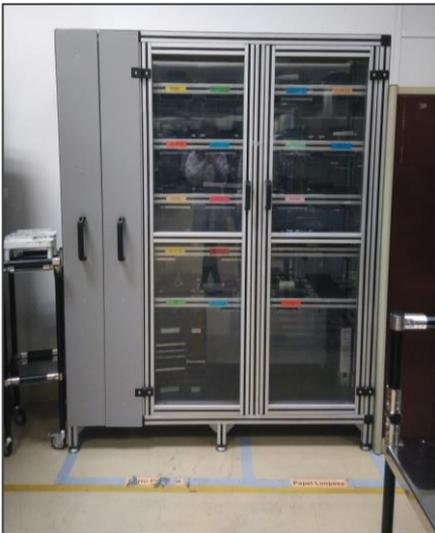
Figura 64 Armazenamento de ferramentas de Pad Print após aplicação de 5S's
