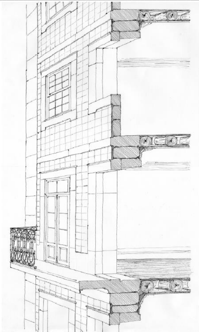
Figura 6.11 – Esquema de um corte transversal da fachada (Fonte: Teixeira, 2004)
