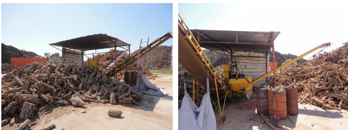
**Figura 59** - *Equipamento e matéria-prima para o descortiçamento mecânico (antes e após o processo)*
