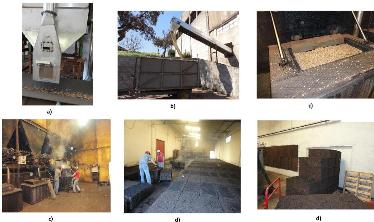
**Figura 60 - Processo de fabrico das placas de aglomerado negro de cortiça.**
