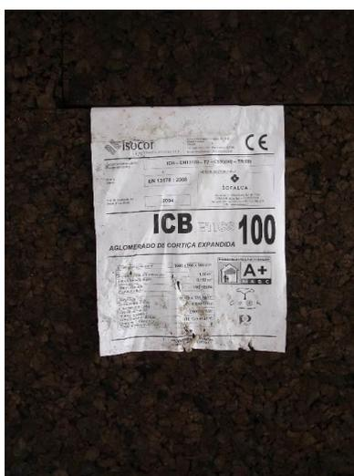
**Figura 64** - Etiqueta das placas de isolamento em aglomerado negro de cortiça
