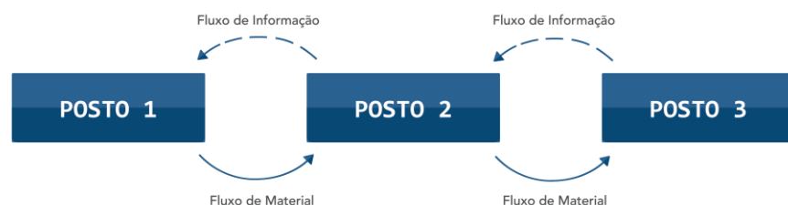
Figura 1- Fluxo de informação e de materiais em sistemas com produção pull. Adaptado de (Bonney et al., 1999)
