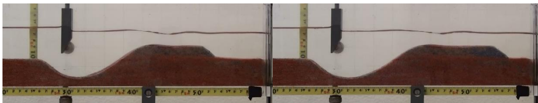
a) b) Figura A.I 3- Perfil para P=2,5 cm no instante t=2:05 min e t=3:05 min
