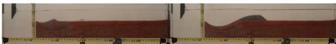
a) b) Figura A.I 68- Perfil para L=9 no instante t=0:37 min (a) e t=7:00 min
