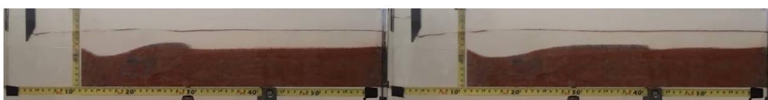
a) b) Figura A.I 18- Perfil para L=9 no instante t=1:30 min (a) e t=7:00 min
