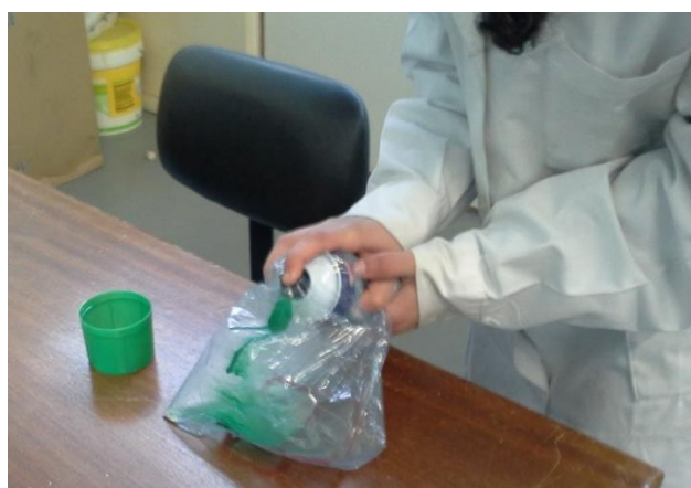
Figura 16- Método usado para pintar areia
