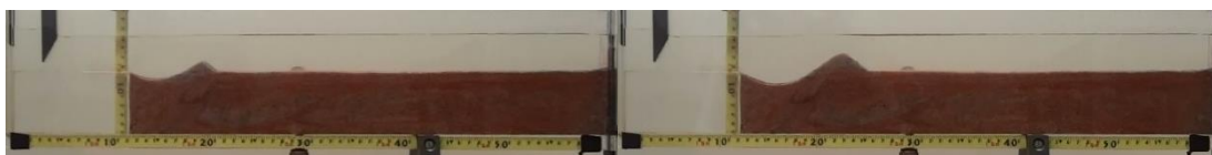
Figura A.I 38- Perfil para L=9 no instante t=2:05 min (a) e t=7:10 min
