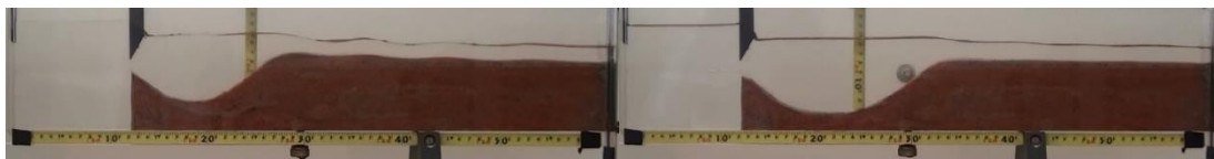
a) b) Figura A.I 14- Perfil para L=0 no instante t=1:50 min (a) e t=6:00 min
