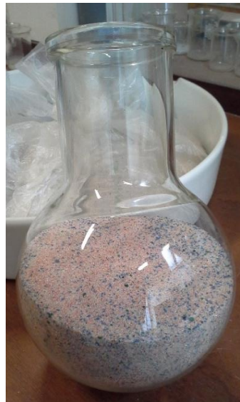
Figura 18- Mistura homogénea das areias pintadas
