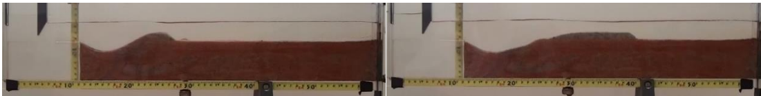
Figura A.I 41- Perfil para L=7 no instante t=1:30 \text{ min} (a) e t=7:10 \text{ min}
