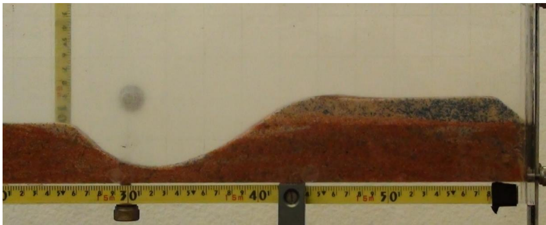
Figura 50- Formação da barra para o ensaio com fundo móvel
