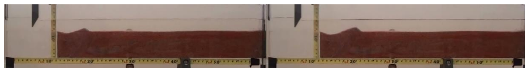
Figura A.I 25- Perfil para L=6 no instante t=2:26 \text{ min} (a) e t=7:16 \text{ min}
