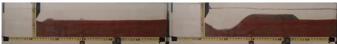
a) b) Figura A.I 94- Perfil para L=0 no instante t=0:25 min (a) e t=7:00 min
