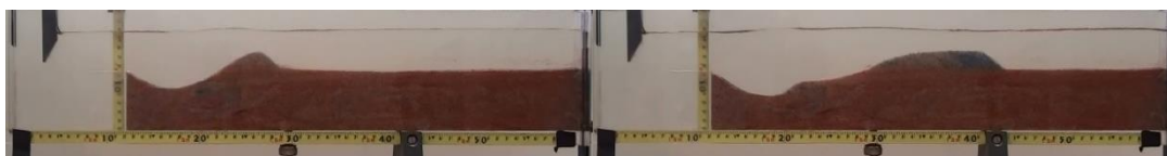
a) b) Figura A.I 23- Perfil para L=9 no instante t=1:10 min (a) e t=7:02 min
