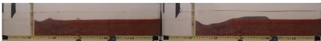
a) b) Figura A.I 88- Perfil para L=9 no instante t=1:04 min (a) e t=7:00 min
