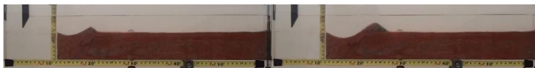
Figura A.I 37- Perfil para L=8 no instante t=2:00 min (a) e t=7:10 min
