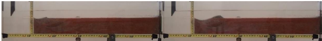
Figura A.I 73- Perfil para L=9 no instante t=0:55 \text{ min} (a) e t=7:00 \text{ min}
