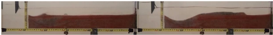
Figura A.I 100- Perfil para L=6 no instante t=0:27 \text{ min} (a) e t=7:00 \text{ min}
