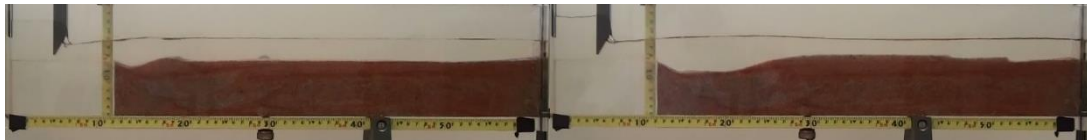
Figura A.I 61- Perfil para L=7 no instante t=0:37 min (a) e t=7:00 min
