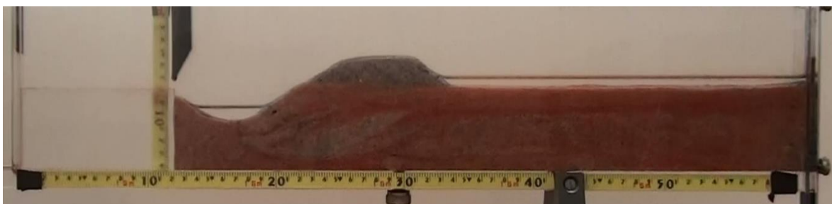
Figura 49- Desmoronamento da Barra durante o esvaziamento
