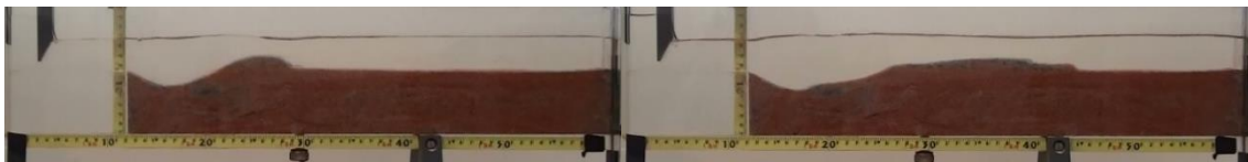
Figura A.I 13- Perfil para L=9 no instante t=2:25 min (a) e t=7:10 min (b)
