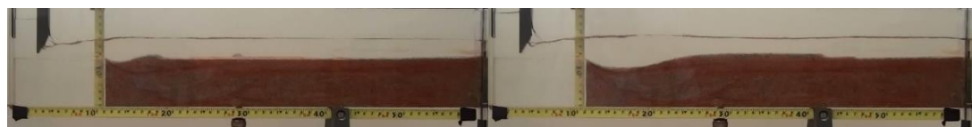
Figura A.I 63- Perfil para L=9 no instante t=0:34 min (a) e t=7:00 min
