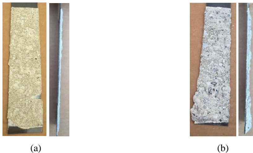
Figura 4.6 - Superfície de fratura dos laminados de CFRP após os ensaios, quando utilizadas diferentes técnicas de preparação da superfície antes da aplicação do adesivo: (a) tratamento com recurso a esmeril (provete GR_Lb200_3); (b) tratamento com jato de areia (provete SB_Lb200_4).
