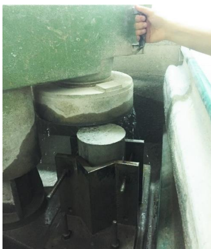
Figura 3.12 - Retificação dos provetes cilíndricos.
