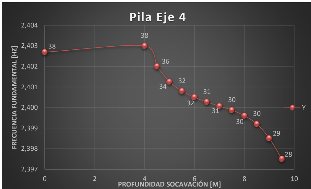
Figura 34. Modelo 2. Frecuencia fundamental vs. Profundidad Socavación. Pila Eje 4, dirección Y. Autor.
