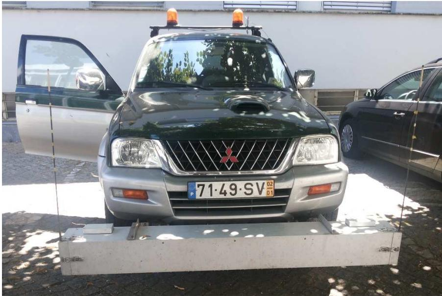
Figura 21 – Perfilómetro a laser, equipamento da Universidade do Minho
