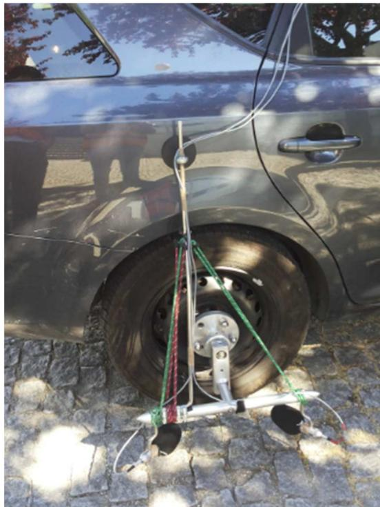
Figura 14 – Método CPX montado no pneu de ensaio
