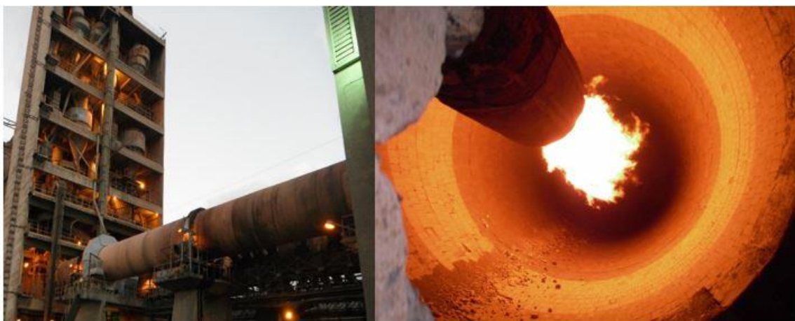
Figura 10 - Forno rotativo e o seu interior.
