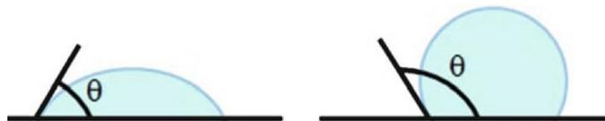
Figura 14: Exemplo de ângulo de contacto de uma superfície hidrofílica (esquerda) e uma superfície hidrofóbica (direita).
