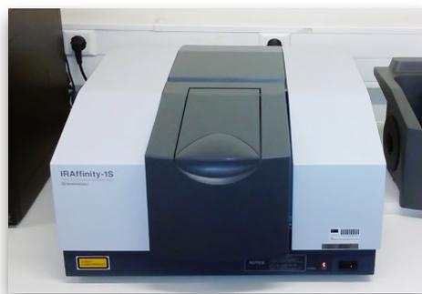
Figura 15: FTIR-ATR utilizado
