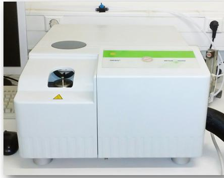
*Figura 18: DSC – 200W de capacidade, com intervalo de temperatura -65°C a 500°C "intercooler" e velocidade de aquecimento/arrefecimento 1 a 20K/min.*
