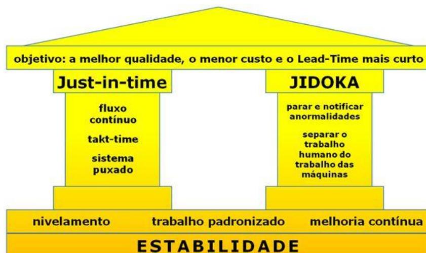
Figura 3: Pilares do sistema TPS (Kond, 2010).
