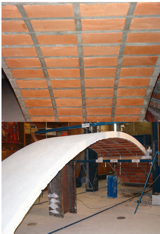
Figura 3 – Casca em alvenaria cerâmica armada construída na Universidade do Minho. Aspecto das juntas de betão(a); vista geral(b).
