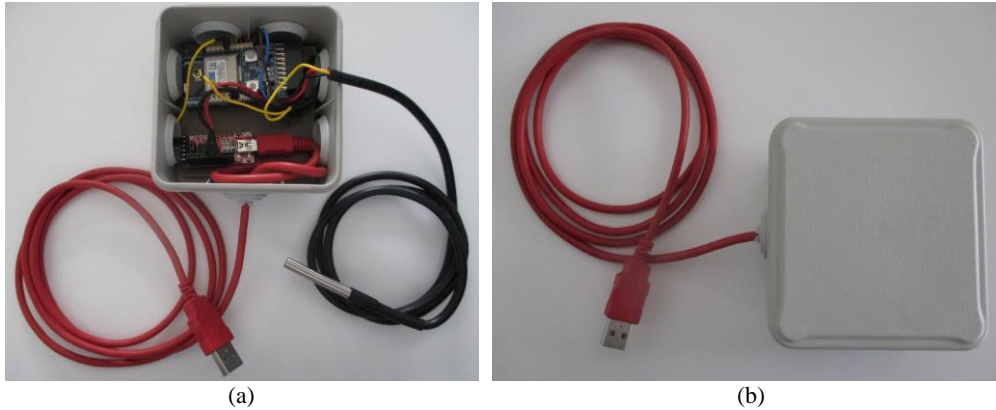
Figura 4.16 - Nó central (a) Encapsulamento; (b) Cabo USB
