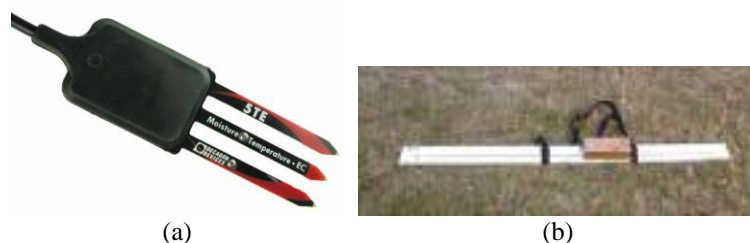
Figura 2.12 - Sensor de condutividade elétrica (a) Sensor de contato; (b) Sensor eletromagnético
