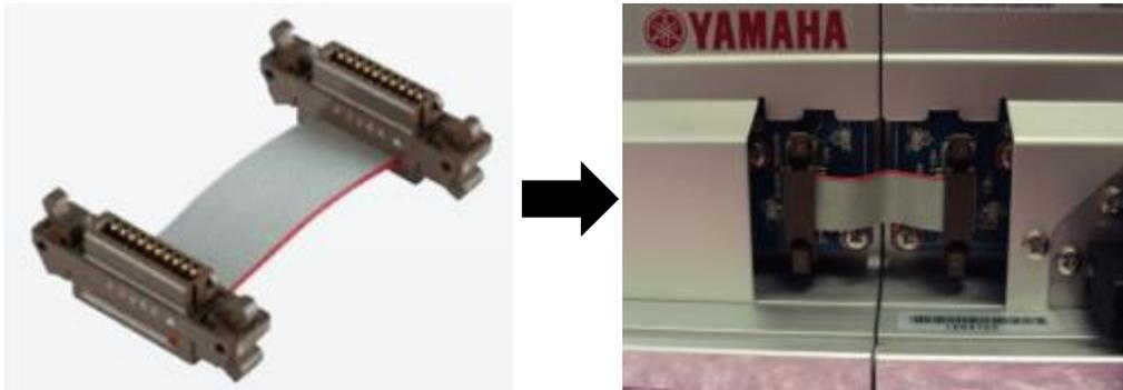
Figura 51 - Cabo de ligação entre dois módulos
