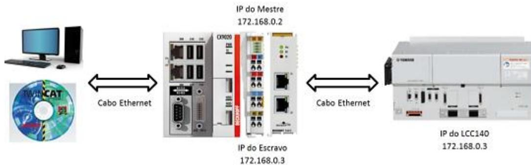
Figura 77 - Rede Ethernet/IP definida entre o PLC e o controlador
