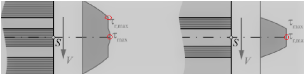
Figura 4.11 – Distribuição de tensão de corte sobre a secção transversal de um elemento CLT carregado para fora do plano, assumindo E_{90, lay} = 0 : camadas longitudinais como camadas superiores (esquerda); Camadas transversais como camadas superiores (direita).
