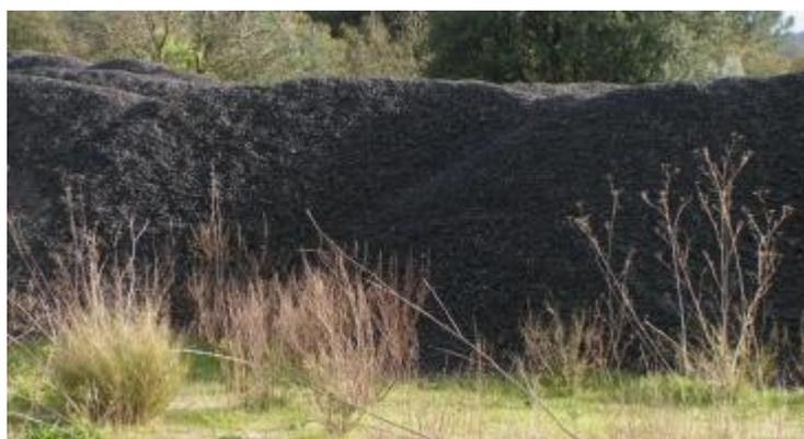
Figura 3. Exemplo de depósito de material proveniente de fresagem (Baptista, 2006).
