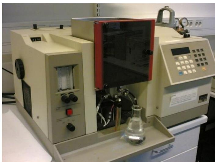
Figura 18. Equipamento para espectroscopia de absorção atômica.
