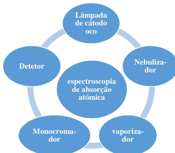
Figura 17. Componentes principais da espectroscopia de absorção atômica.
