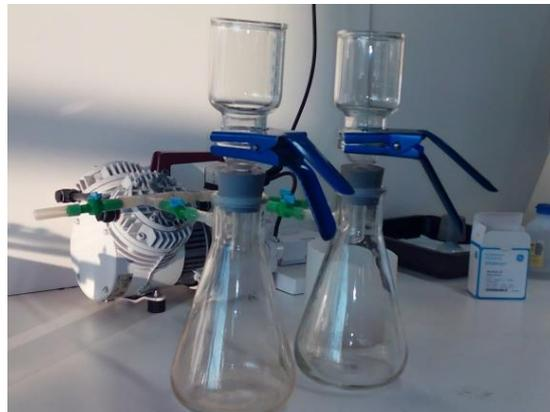
Figura 16. Equipamento para filtragem a 45.
