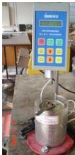
Figura 10. Equipamento *Brookfield* utilizado no ensaio de viscosidade rotacional.
