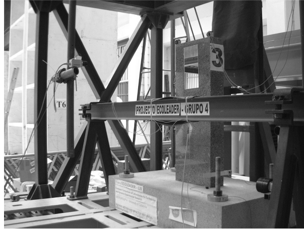
Figura 4: Instrumentación de las probetas con sistemas LED-espejo-cámara
