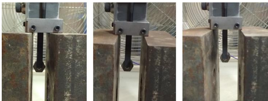
Figura 47 – Ensaio efetuado com diferentes distâncias entre apoios
