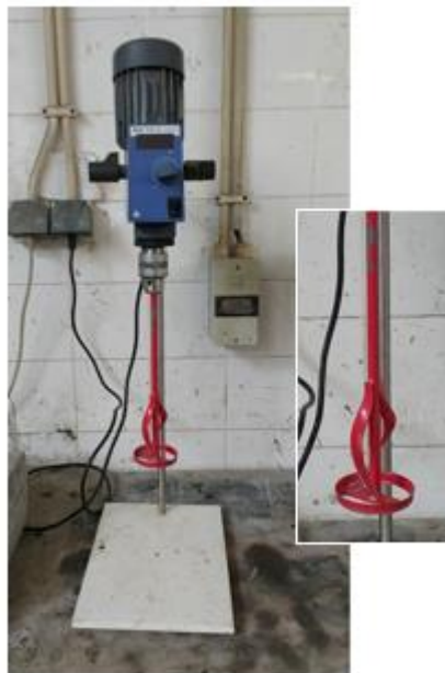
Figura 20 – Agitador IKA RW 20 e pá de mistura
