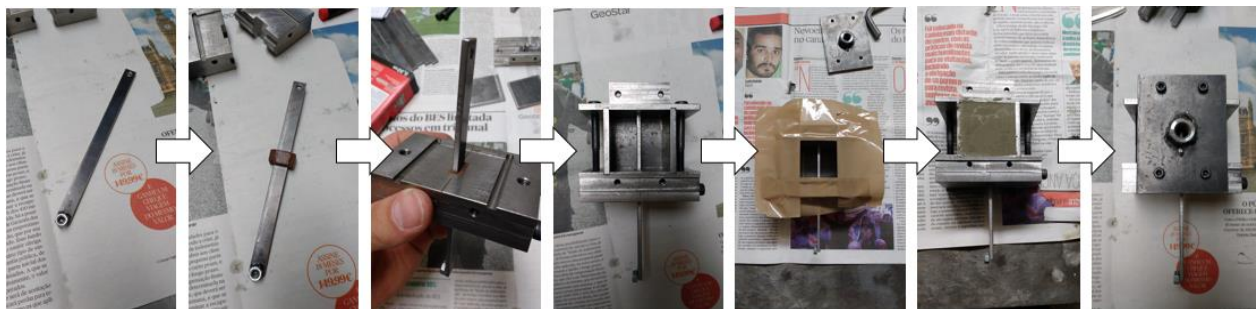
Figura 41 – Montagem e preenchimento do molde
